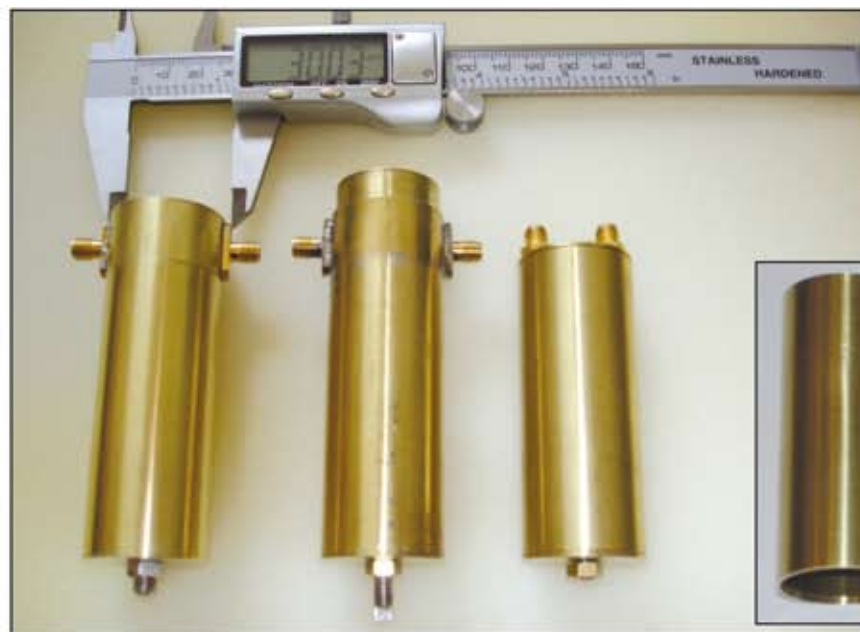
I tre filtri descritti. Da sx il passa basso, il passa alto e il passa banda.
