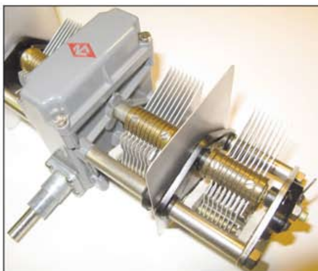
Fig. 5 - Il condensatore variabile utilizzato nei primi anni di produzione dell'HRO ed il relativo meccanismo di comando; notare la costruzione a "sandwich" con le lamine di schermatura, i pattini striscianti di contatto, gli statori ed i rotori.
