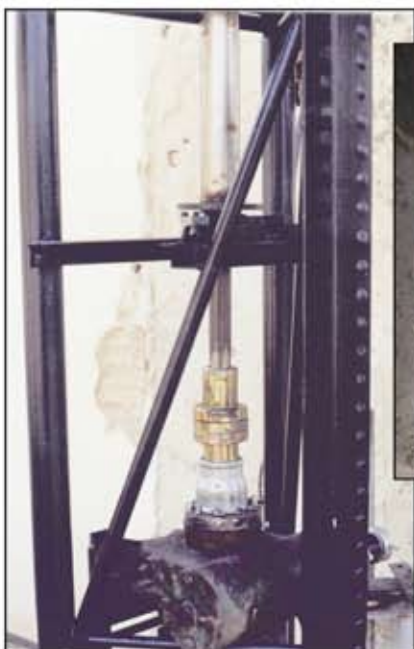
Il grosso argano posto rialzato alla base del traliccio: si notano il giunto a tre pezzi (giunto Oldham) per correggere eventuali disallineamenti dell'asse; a questo veniva accoppiato un'altra vite senza fine con motorino da 1500 giri (nella foto al centro, con control box e interruttori di fine corsa).
