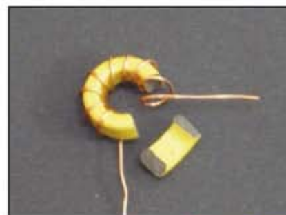
Foto 2 - Effetto dell'eccessiva trazione del filo.
