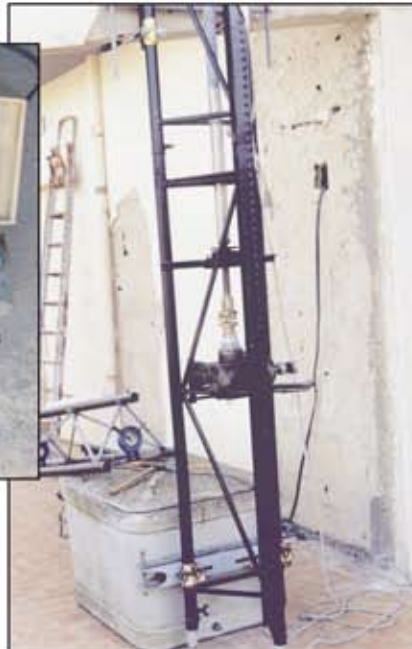
Il grosso argano posto rialzato alla base del traliccio: si notano il giunto a tre pezzi (giunto Oldham) per correggere eventuali disallineamenti dell'asse; a questo veniva accoppiato un'altra vite senza fine con motorino da 1500 giri (nella foto al centro, con control box e interruttori di fine corsa).
