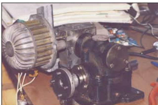
In primo piano l'ingranaggio in bronzo del Collins accoppiato al motorino e vista d'insieme (questo è il rotore "indoor").
