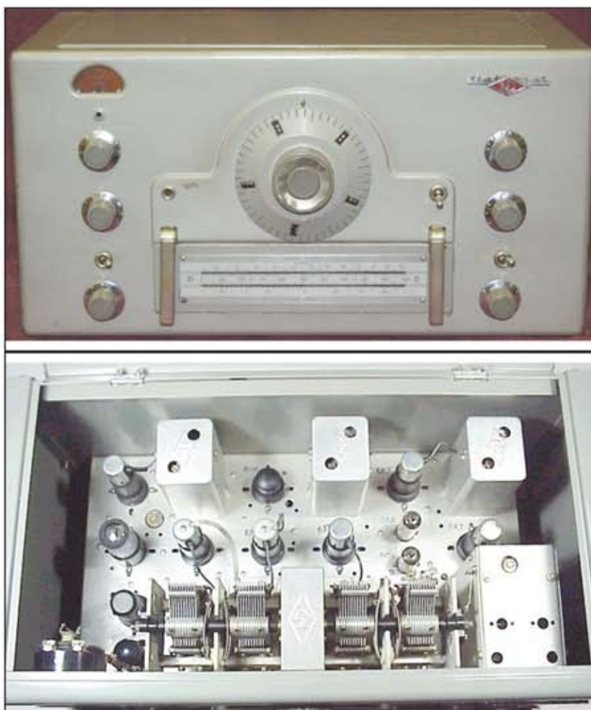
Fig. 13 - HRO 7: modello successivo dell'HRO-STA1, del quale conserva l'architettura circuitale. Notare l'inserzione della valvola stabilizzatrice OA2 e la 6C4 in sostituzione della 6J7.
