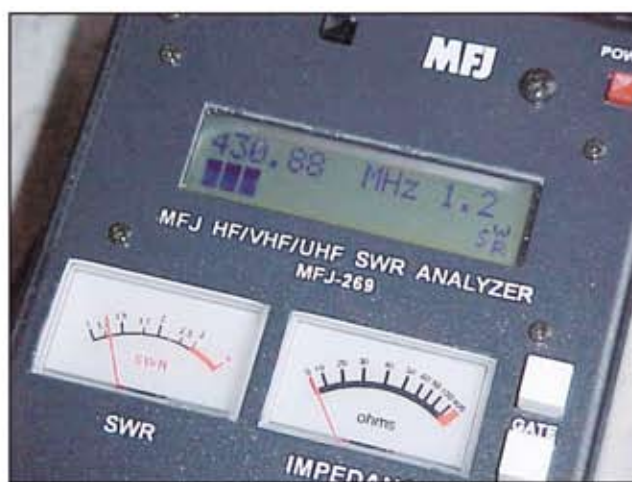
La foto mostra i valori sulla frequenza di 430 MHz della mia J antenna applicata all'MFJ 269
