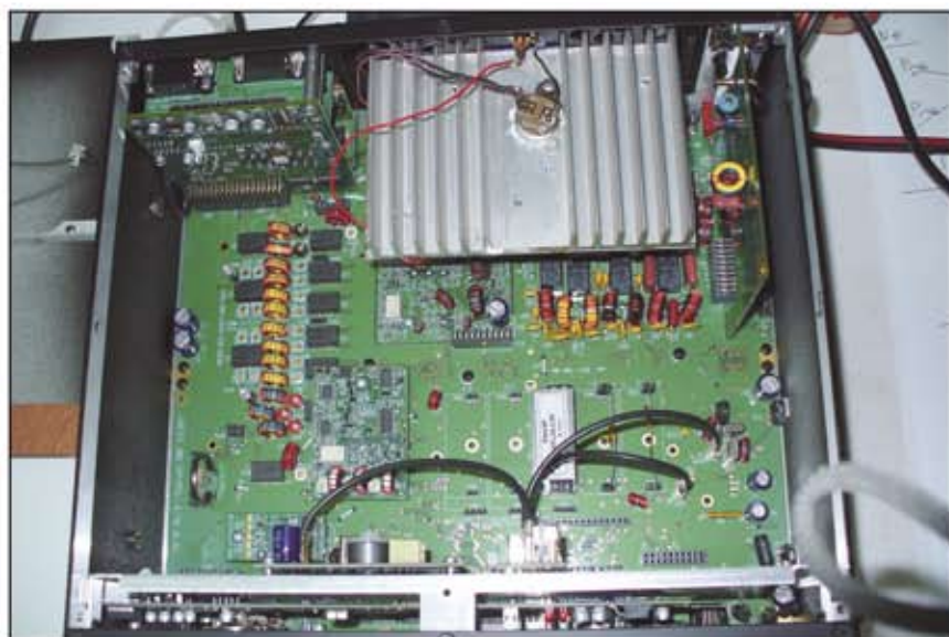
A sinistra filtri TX, a destra filtri RX c/relé, al centro zoccoli per filtri Roofing. Il grosso dissipatore contiene l'unità 100 watt.
