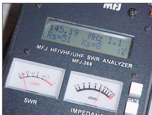
La foto mostra i valori sulla frequenza di 145 MHz della mia J antenna applicata all'MFJ 269
