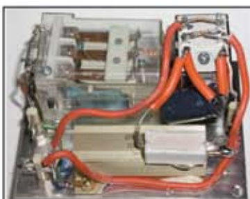
Piastina circuiti di avviamento e protezione T1 Sono visibili RL5-6-C1-D1-R1-2
