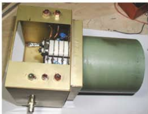
Vista completa con camino montato. In basso il BNC di ingresso
