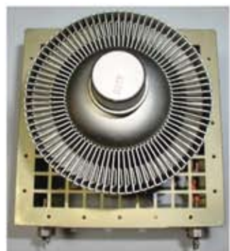
Scatola pressurizzata con zoccolo vista da sotto. Le cinque R in parallelo che si vedono sul lato destro sono state poi sostituite con un'unica R1. Da notare il fondo reticolato per il passaggio della ventilazione con blocco della RF. Sulla sinistra l'apertura di imbocco per il ventilatore.
