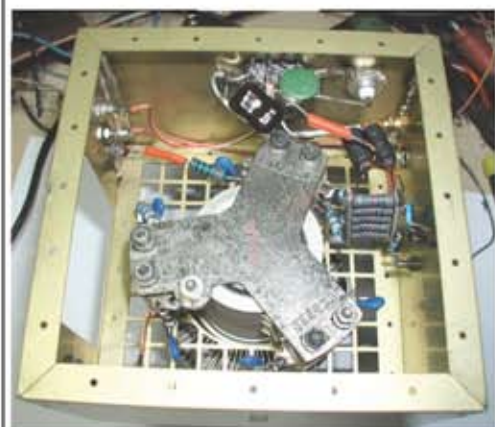
Scatola pressurizzata con zoccolo vista da sotto. Le cinque R in parallelo che si vedono sul lato destro sono state poi sostituite con un'unica R1. Da notare il fondo reticolato per il passaggio della ventilazione con blocco della RF. Sulla sinistra l'apertura di imbocco per il ventilatore.
