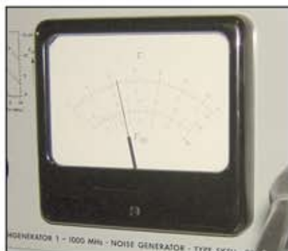
Fig. 23 - Misura della Cifra di Rumore col generatore R&S tipo SKTU.
