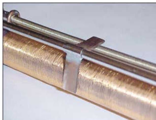
Particolare del contatto strisciante. Si noti la forma ad L e la piegatura dei lembi (vedi testo)
