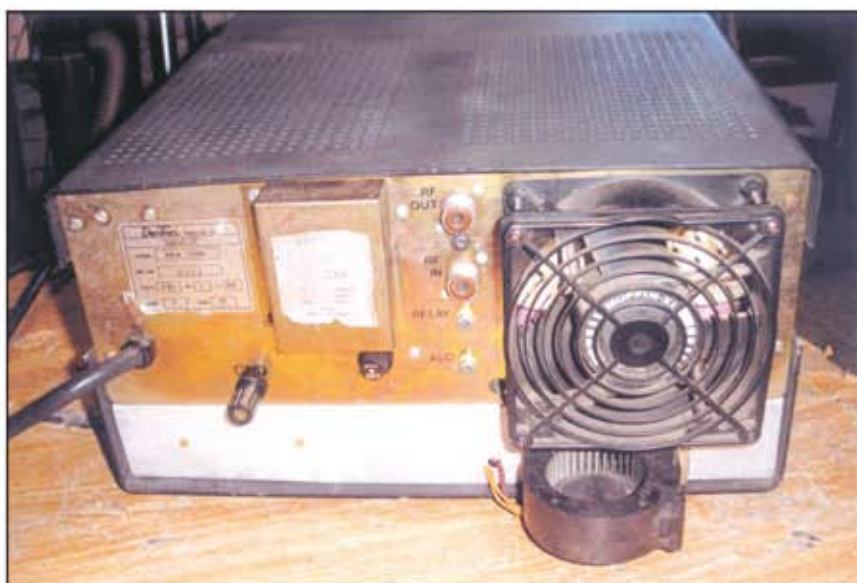
La parte posteriore dell'amplificatore, si evidenzia la ventola principale e sotto, quella aggiunta.
