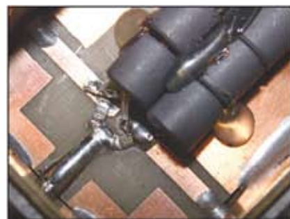
La foto 4 fa vedere come sono saldate allo stampato le due resistenze in modo simmetrico
