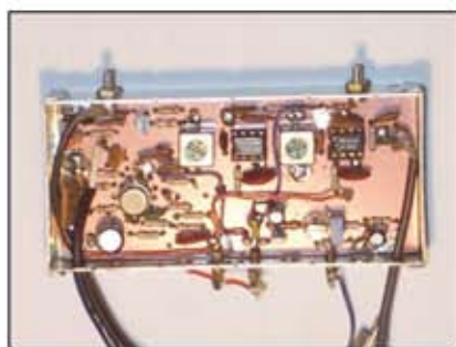
Foto 3 - Unità IF montata e sciolata
