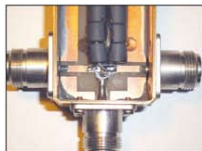
La foto 3 fa vedere il ponte vero e proprio con le due resistenze SMD ed il cavo coassiale saldato allo stampato
