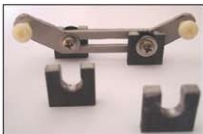
Foto 5 - Particolare del prototipo della barretta con gli isolatori per i contatti elettrici.
