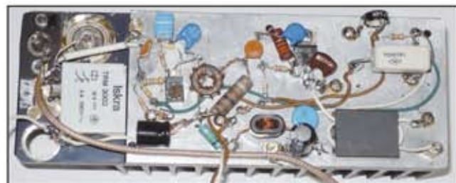
Vista della piastra di dissipazione con montato l'amplificatore. A sx i connettori di ingresso ed il relè di antenna. TR1-2 sono montati con mica isolante e grasso silicone. In alto il trimmer per la polarizzazione di TR2 (50 mA).
