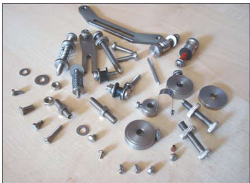
Foto 7 - Le parti in acciaio AISI 316 che compongono il bug
