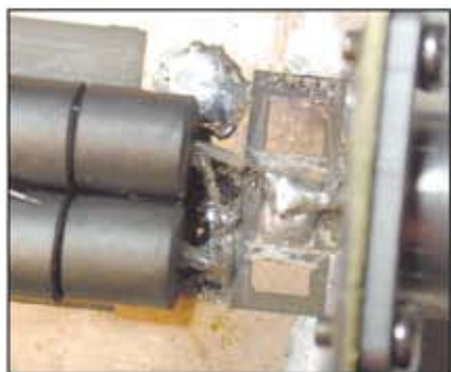
La foto 6 fa vedere la porta di uscita del ponte, il cavo coassiale saldato ed il connettore N di uscita.
