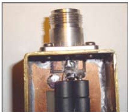
La foto 5 fa vedere il lato della porta di uscita
