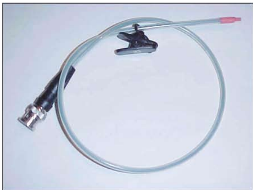
L'antenna avvolta a realizzazione ultimata. Si noti la CLIP in plastica per poterla agganciare allo zaino
