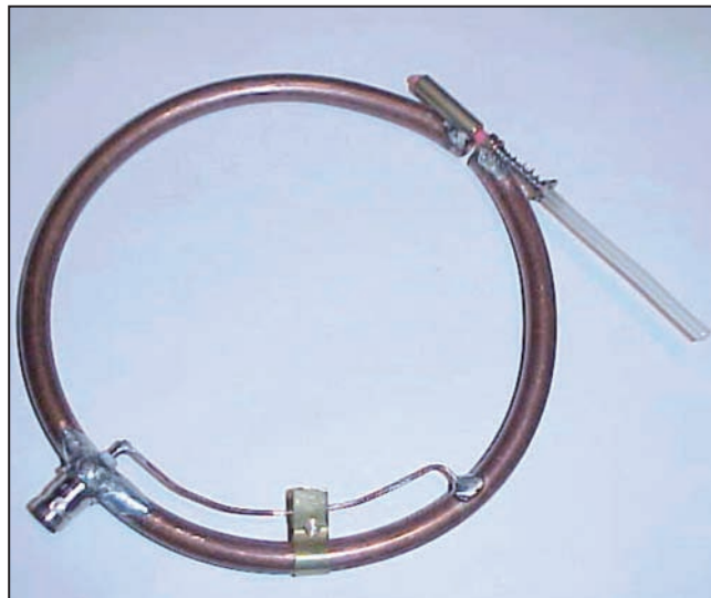
La loop antenna per i 144 MHz a realizzazione ultimata
