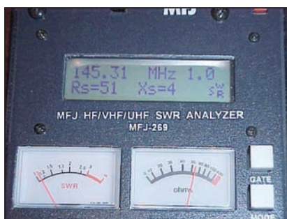
La loop antenna applicata allo MFJ 269 e i dati che se ne ricavano dopo la taratura
