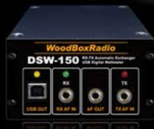
DSW-150 RX - TX Antenna Switch con incorporato Ros/Wattmetro su porta USB
