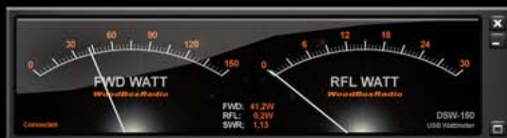
DSW-150 RX - TX Antenna Switch con incorporato Ros/Wattmetro su porta USB
