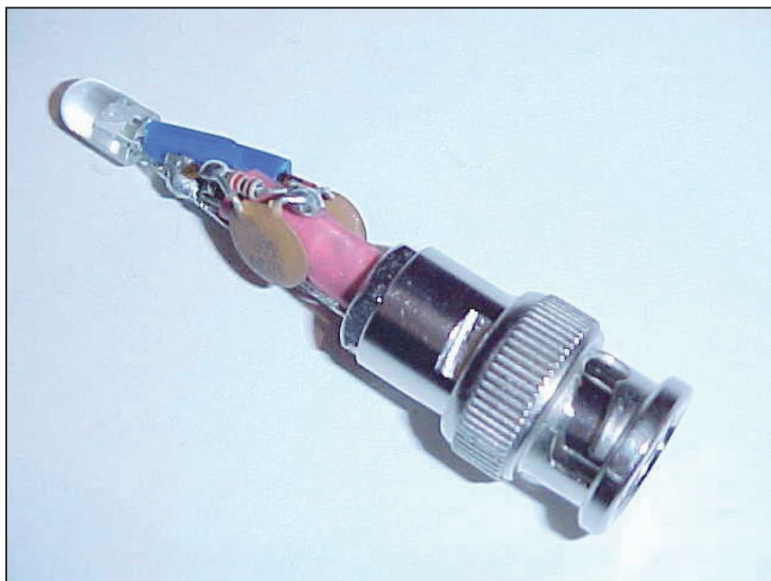
La foto mostra il carico fittizio con diodo LED a realizzazione ultimata
