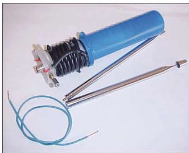
L'antenna "personalizzabile" a realizzazione ultimata e il materiale che la compone
