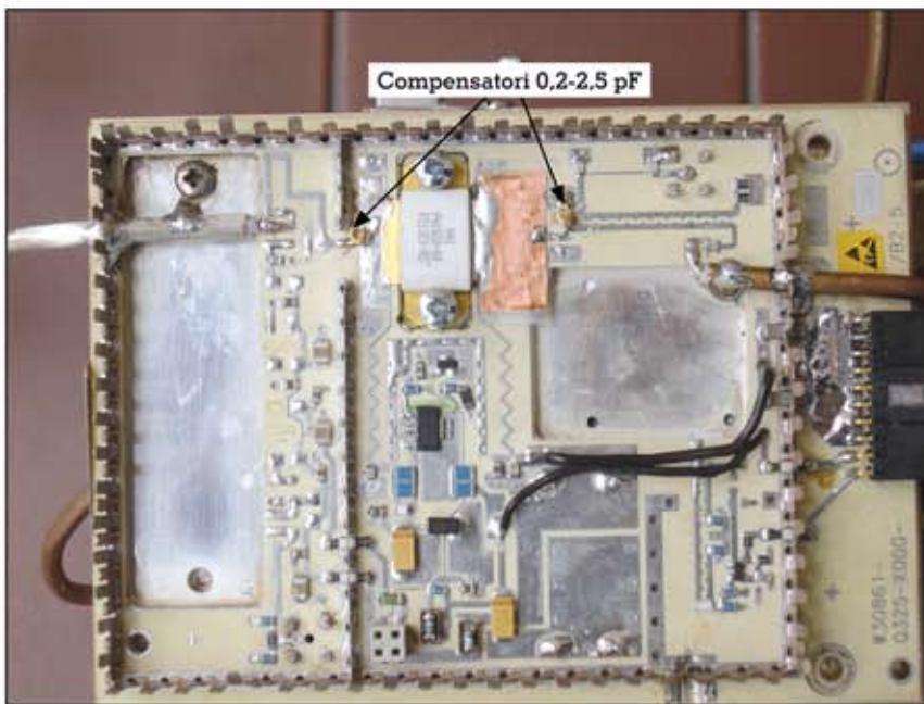
Foto 2 - Fase 1, i compensatori utilizzati sono Gigatrimmer in zaffiro Johanson-Tekelek (RF elettronica).
