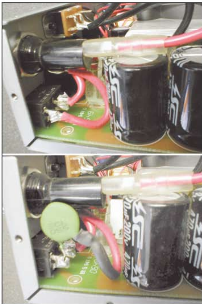
Foto 4 - Montaggio dell'NTC nell'alimentatore
