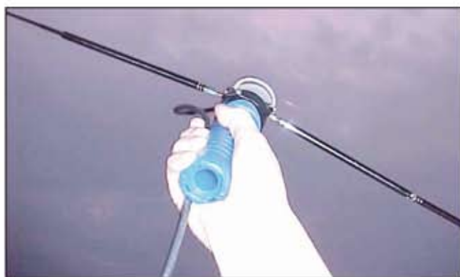
L'utilizzo dell'antenna nella configurazione dipolo direttivo.
