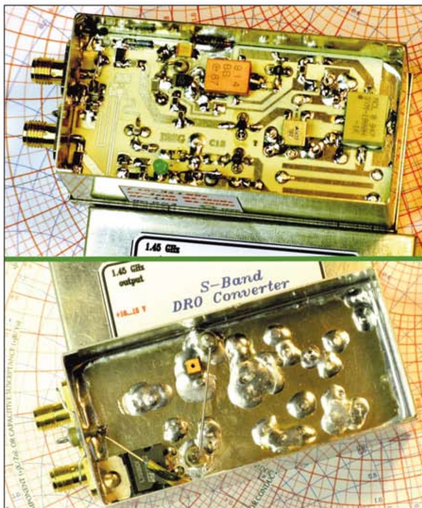
Fig. 6 - Il secondo esemplare costruito: vista lato microstrip e lato piano di massa.
