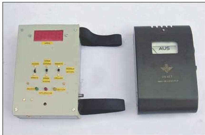
Fig. 3 - Il geiger con l'unità aggiuntiva: i due lacci elastici vanno passati intorno al corpo del contatore, dopo aver inserito il Jack.
