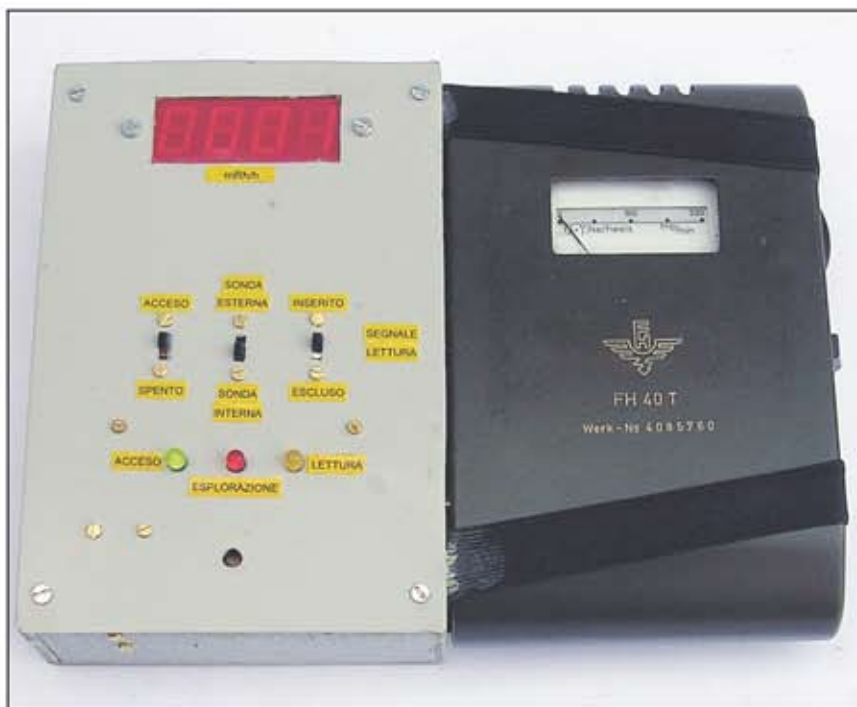
Fig. 4 - Disposizione dell'unità di conteggio per l'uso della sonda interna.
