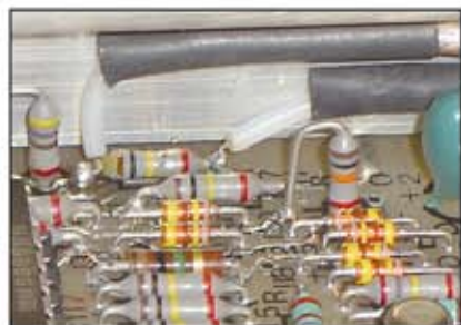
Fig. 16 - Connessione ai punti "A"-A" dei cavetti schermati provenienti dal potenziometro aggiunto.
