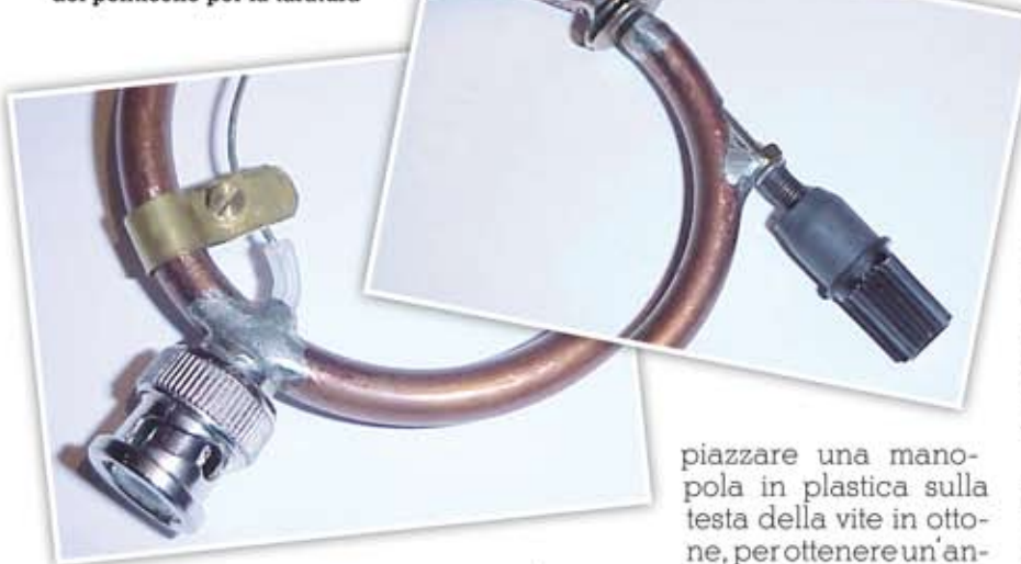
Particolare della spina BNC e del ponticello per la taratura
