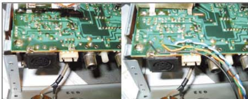
Foto 1 - Connettore J02 CAT del FRG9600 liberato dallo schermo. Prima e dopo le connessioni.
