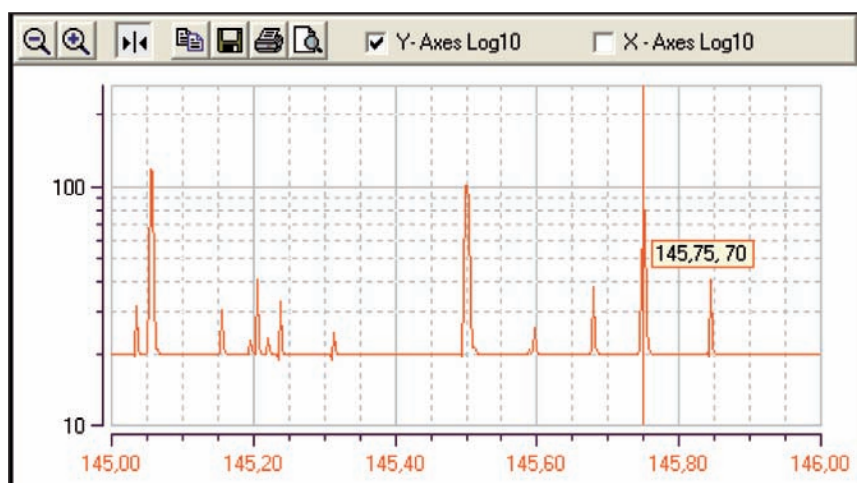
Fig. 6- Esempio di scansione: alcuni segnali in banda 144 MHz. Ampiezze arbitrarie.
