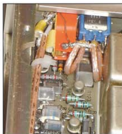
Fig. 18 - Veduta dei componenti aggiunti (potenziometro ed interruttore) nella parte interna del frontalino del "modulo 4".
