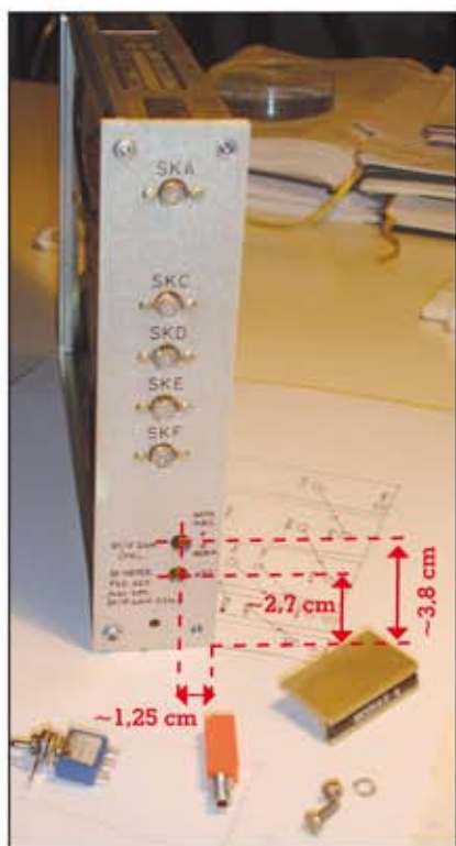
Fig. 15 - I due nuovi fori da praticare sul frontalino del "modulo 4" ed alcuni dei componenti impiegati nell'effettuazione della modifica.
