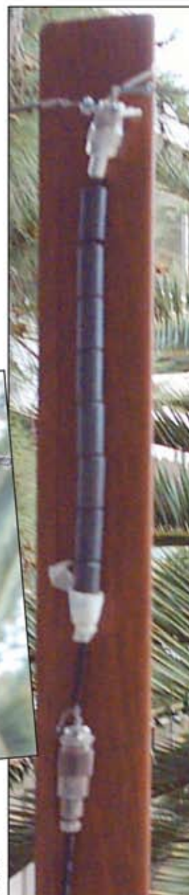
Fig. 2 Palo dell'antenna con balun
