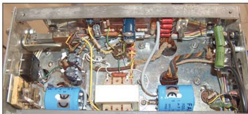
Particolare inferiore del telaio dopo la sostituzione dei condensatori elettrolitici
