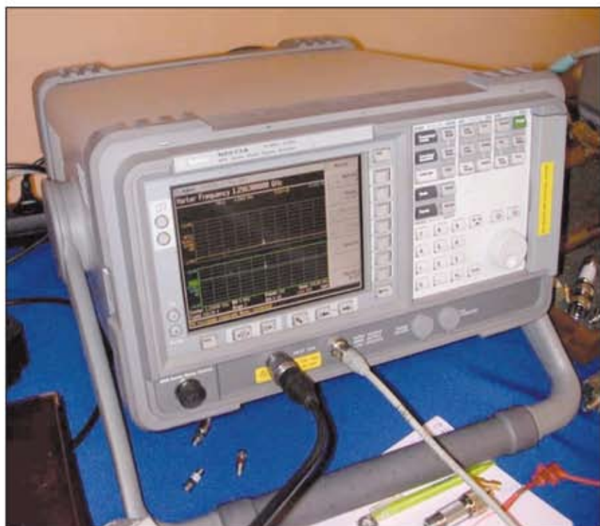
Foto 7 - Grafico di NF e Gain a 1296,300 MHz su Noise Analyzer della Agilent mod. N 8973 A
