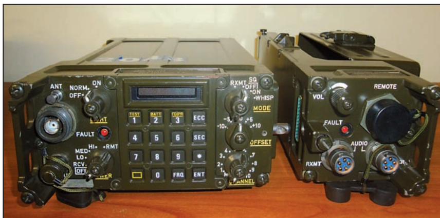
Foto 1 - I moduli RT-3088 e AU-4088 sganciati e vano batteria aperto
