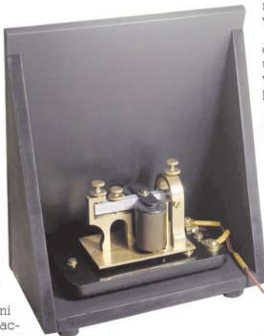
Fig. 1 - Un classico sounder americano (con leva in alluminio) prodotto dalla J. H. Bunnell & Co. di New York su proprio brevetto del 1895, utilizzato sulle brevi distanze dalle compagnie ferroviarie: il suo avvolgimento è da 4 \Omega . La foto lo mostra installato all'interno di un risonatore costruito come indicato in fig. 5.
