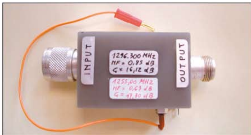
Foto 6 – L'LNA per i 1296 MHz inserito nel contenitore di ottone e coperchio in PCB
