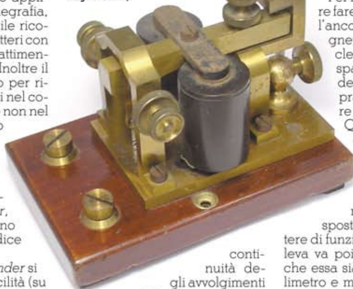
Fig. 2 - Un raffinato sounder in ottone e mogano per linee a grande distanza (resistenza addirittura 900 \Omega !) utilizzato ai primi del Novecento negli uffici postali britannici (è infatti marcato GPO, ossia General Post Office, le "Poste e Telegrafi" del Regno Unito).
