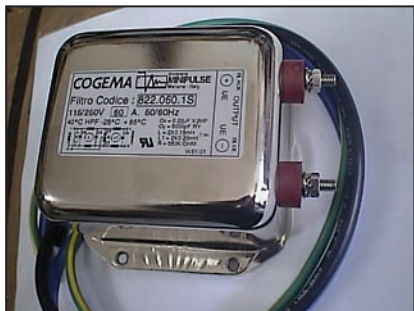
Foto 4 Filtro di rete da 60 A
