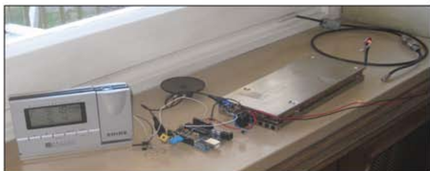
Fig. 8 - Beacon con il TX che alimenta un carico fittizio costituito da resistori e una lampadina
