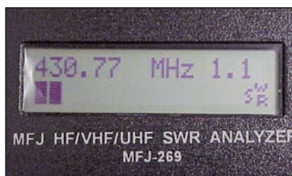
I dati rilevati dall'MFJ 269 sulla frequenza di 430 MHz.
