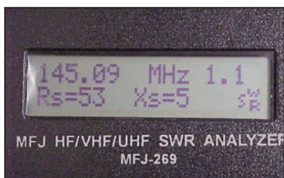
I dati rilevati dall'MFJ 269 sulla frequenza di 145 MHz.
