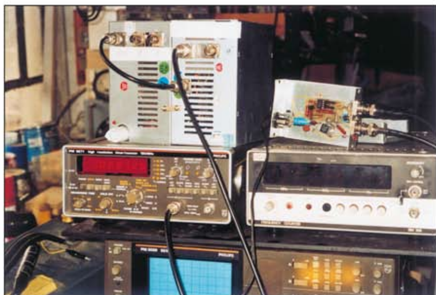
Foto 2 - Vista d'insieme dei tre componenti. La prima scatola contiene l'oscillatore a 10 MHz; nei due BNC liberi sono disponibili i segnali a 5 e 1 MHz. Nella seconda scatola c'è il convertitore che trasforma il 10 MHz in 156,25 e 1562,25 kHz. Nello scatolino aperto c'è il prescaler.
