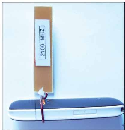
Fig. 2 - Mini antenna in opera. La posizione migliore va ricercata sperimentalmente.
