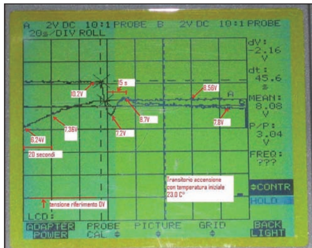
Fig. 6 - V_f e V_r nel transitorio di assestamento dopo l'accensione (scala tempi 20s/divisione).
