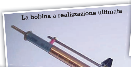
Particolare ingrandito del contatto strisciante a forma di V
