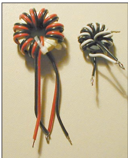
Foto 4 - I due balun di prova appena avvolti.
