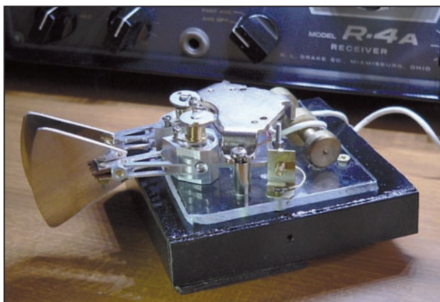
Fig. 6 - Chiave realizzata con parti di un hard disk
