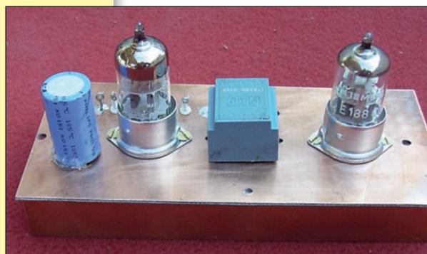
Foto 7 - Il modulo preamplificatore a R.F. ed amplificatore di B.F.
