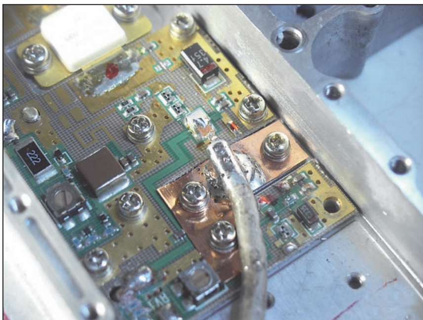
Foto 5 - Particolare del circuito di ingresso, si noti che in questo caso, avendo usato un coassiale tipo UT141 il collegamento, tra il centrale del cavetto ed il condensatore, è stato fatto con una sottilissima strisciolina di rame evitando così una rigidità che potrebbe portare in seguito alla rottura dell'armatura del condensatore.
