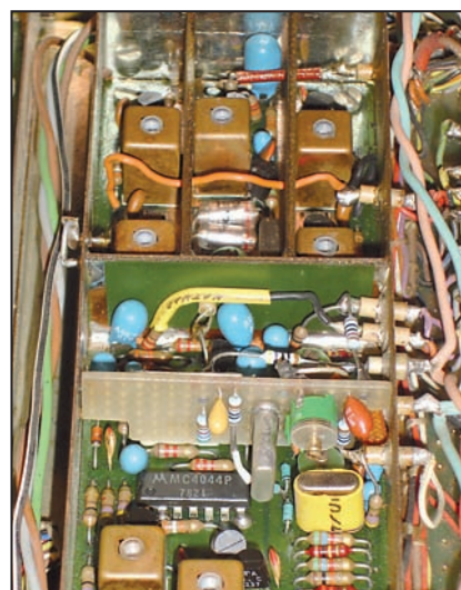
Fig. 9 - La basetta di cui alla Fig. 8 già inserita all'interno del modulo CLARIFIER LOOP e veduta dal lato componenti.
