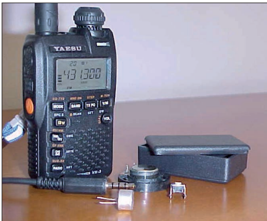
Il ricetrasmittitore Yaesu VX3 e i diversi componenti impiegati nella realizzazione del microfono parla ascolta
