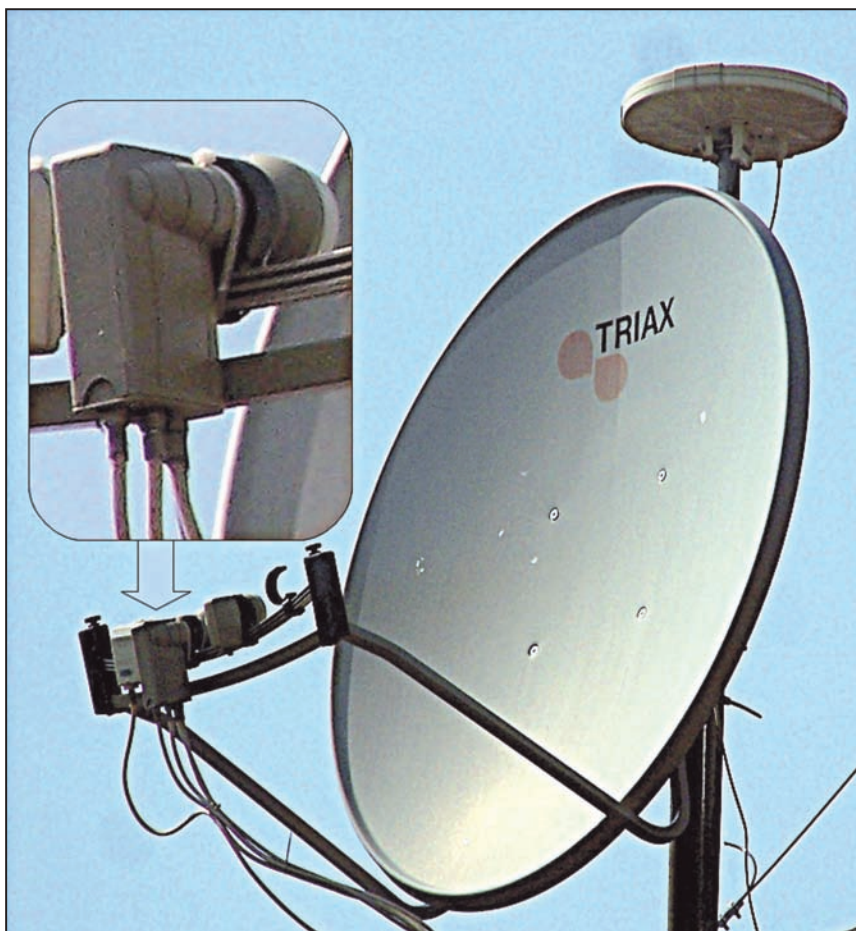
Fig. 2 - La mia parabola con l'LNB a quattro uscite indipendenti.
