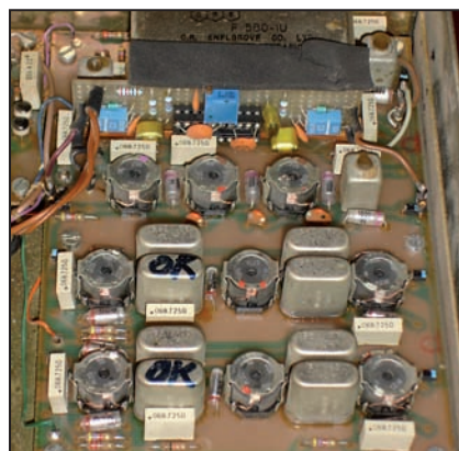
Fig. 17 - Vista del modulo IF Filters (in versione completa); si noti la nuova basetta posizionata sul fianco del filtro incapsulato.
