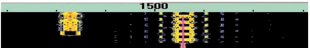
Fig. 7C - Segnale generatore con transizione a gradino "dura"
