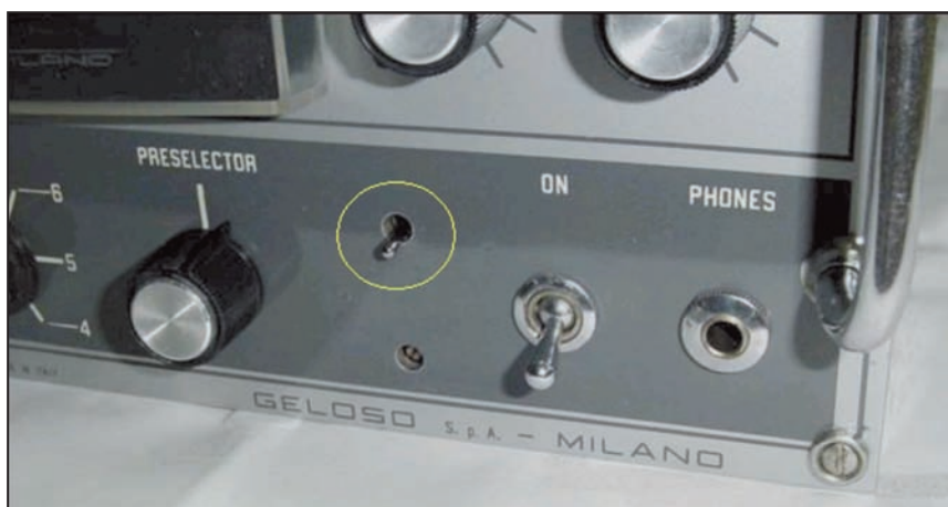
Qui è visibile l'interruttore del convertitore.
