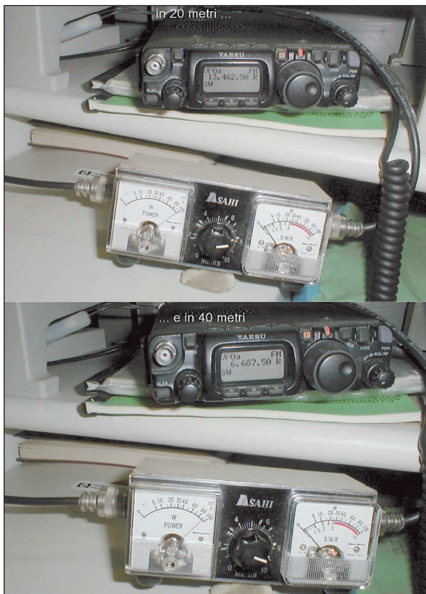
Foto 1 - Il controllo con il ROSmetro
