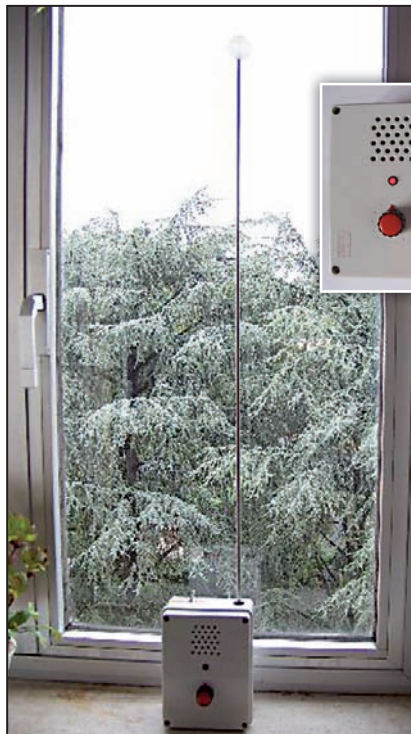
Fig. 4 - Il rivelatore di temporali in funzione.
