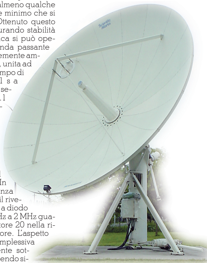
Fig. 5 - Antenna da 7 m di diametro operante presso il Centro Radioastronomico Bagnara di Romagna www.CRBR.IT
