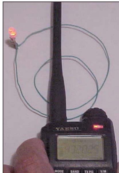
Il circuito ON AIR 2 acceso, posto vicino all'antenna dello Yaesu VX3.
