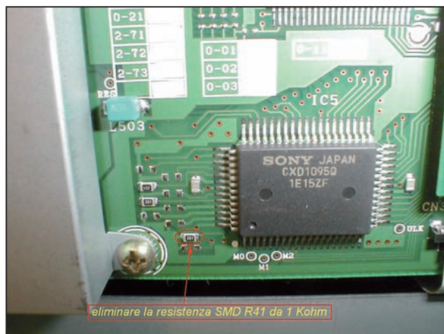
Foto 4A - Particolare della control board prima della modifica
