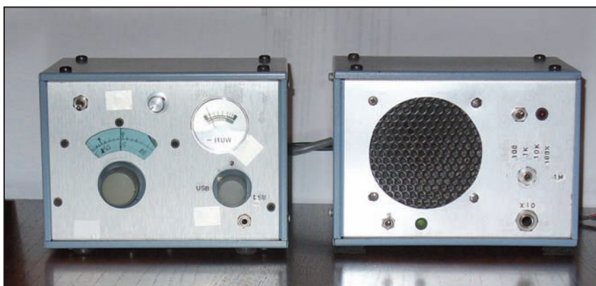
Foto 3 - Il mio terzo QRP; l'unità a sinistra è il ricevitore completo, può funzionare singolo; a destra l'unità trasmettitore, funziona tramite il VFO dell'RX e fornisce 5 watt oppure 2 watt selezionando il livello di uscita.
