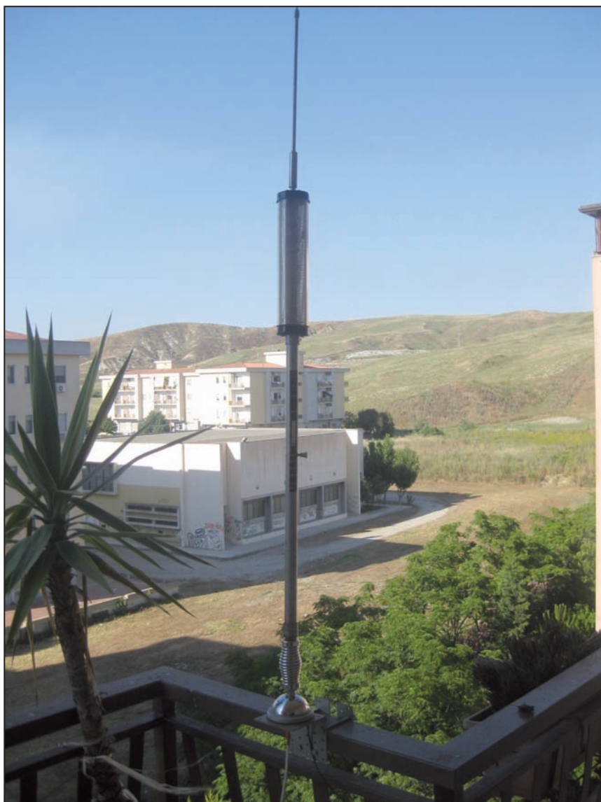
La bobina d'accordo a nove posizioni della Swantenna model 45
