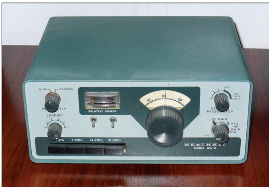
Foto 2 - Il mio secondo QRP; è l'HW 8; delle numerose modifiche appare solo lo strumentino che diventa multi indicazioni tramite i due interruttori posti sotto
