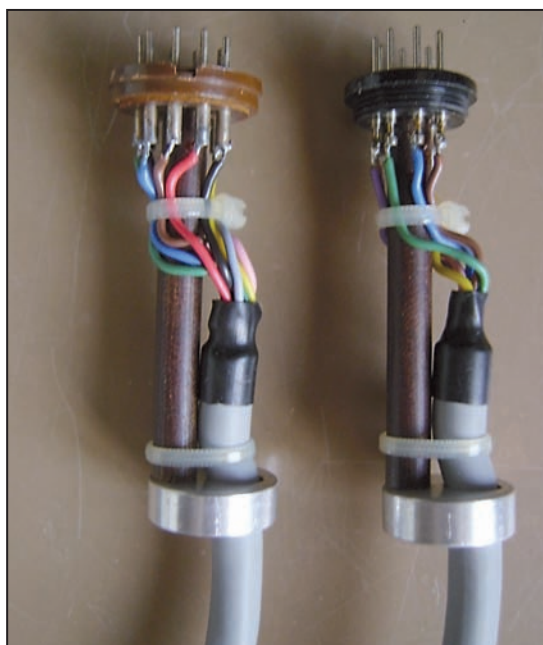
Fig. 8-9-10 - Particolari costruttivi dei probes sette e nove piedini
