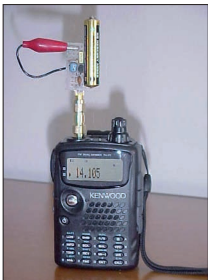
L'amplificatore dell'antenna attiva applicato al ricetrasmittitore Kenwood TH F7 sintonizzato sulla banda dei 20 m
