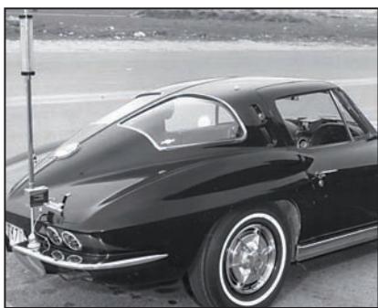
La Swantenna 55 con sistema d'accordo motorizzato alla base.
