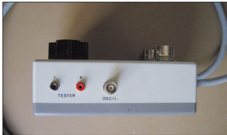
Fig. 7 - Vista laterale con boccole per tester e BNC per oscilloscopio
