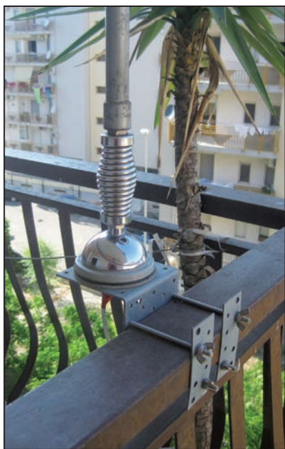
La bobina d'accordo a nove posizioni della Swantenna model 45
