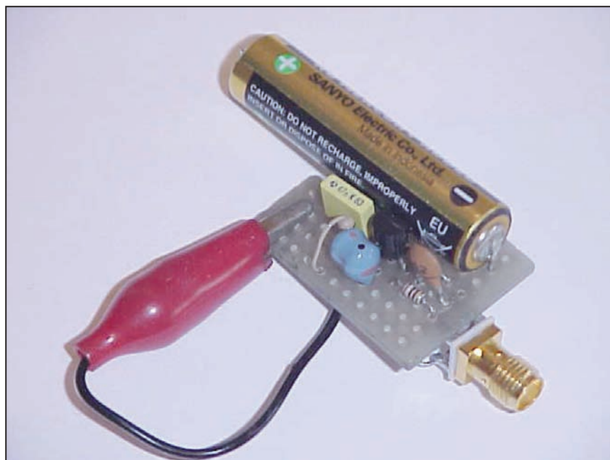
L'amplificatore a larga banda a realizzazione ultimata. Si noti la pinzetta a coccodrillo, di colore rosso, utilizzata come interruttore
