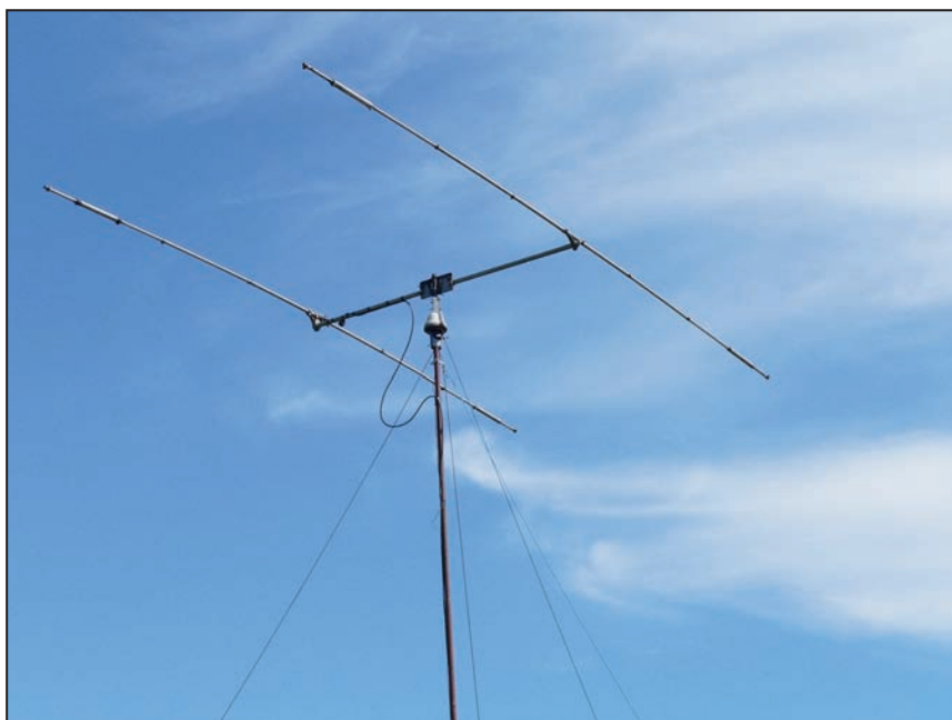
Foto 5 - Yagi accorciata per i 17 m
