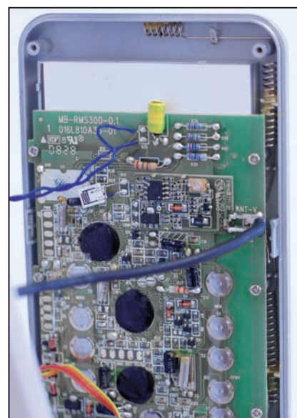
Foto 1 - Particolare dell'antenna ricevente e della derivazione realizzata.
