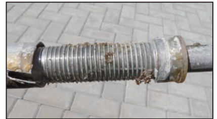
Foto 3 - Trappola Yagi prima della pulizia
