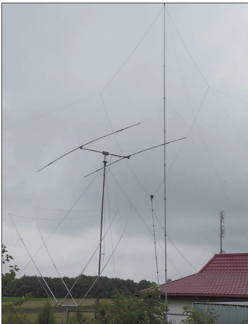
Foto 7 - GP - Loop dei 17 e 2 el. Yagi tribanda.
