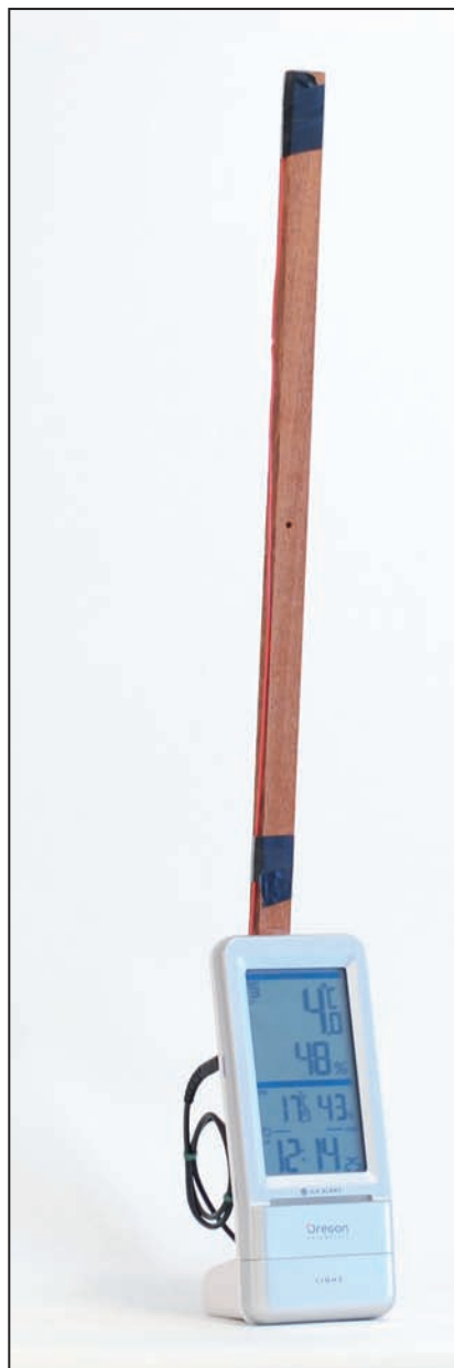
Foto 3 - La stazione meteo completa di antenna J-pole
