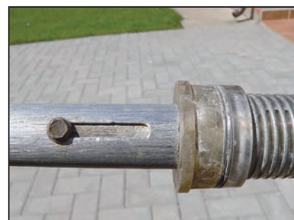
Foto 1 - Regolazione risonanza trappola
