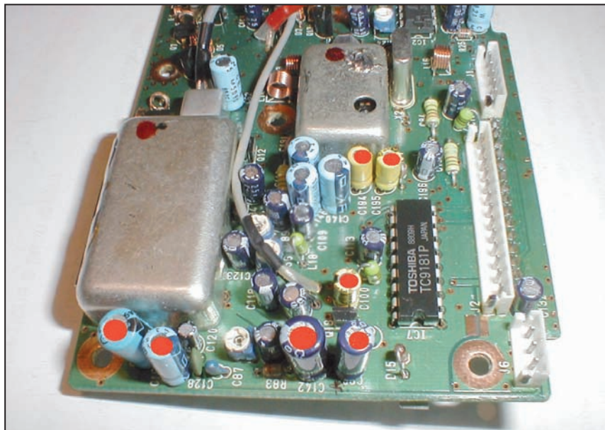
Foto 2 - I condensatori sostituiti sono segnati da un puntino rosso
