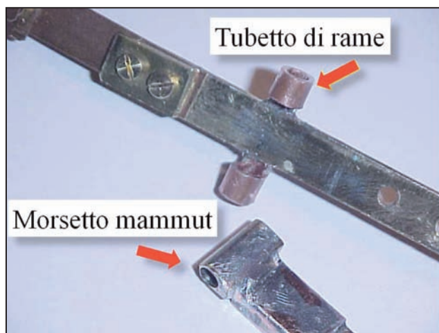
La preparazione della cerniera del braccio mobile. Si noti come sono stati saldati a stagno, il morsetto mammut e il tubetto di rame opportunamente limato.
