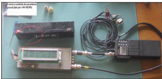
Vista di insieme con RTX FT23 in low power (100mW): il resistore coax da 50 \Omega carica l'uscita per contenere V_g a <5V. L'interruttore a levetta mantiene il TX ON.
