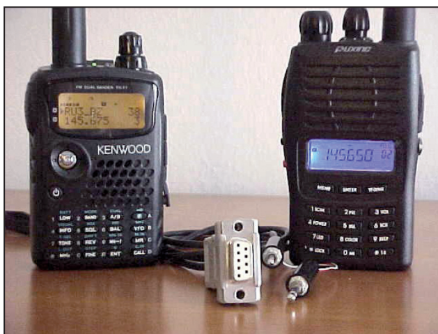
Il Kenwood TH F7 e il Puxing PX-777 che è possibile programmare con l'interfaccia presentata
