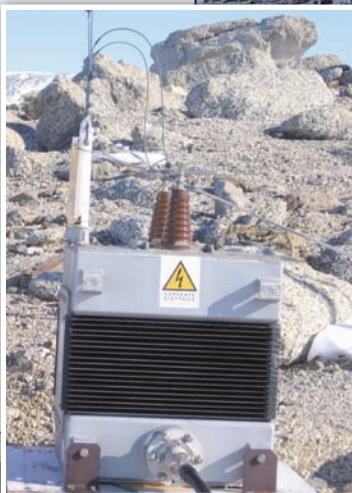
Ponte radio VHF in banda aeronautica situato sul monte Melbourne, un vulcano attivo a 50 km dalla base.
