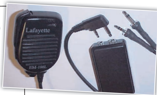
L'adattatore a realizzazione ultimata. Si notino i due spinotti jack isolati con guaina termo restringente.
