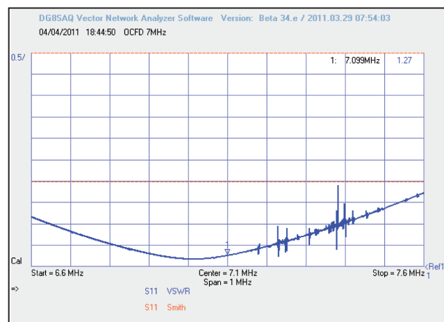
Fig. 12 - SWR misurato dell'antenna in banda 7 MHz. Gli spike presenti non sono errori di misura ma forti segnali in banda.
