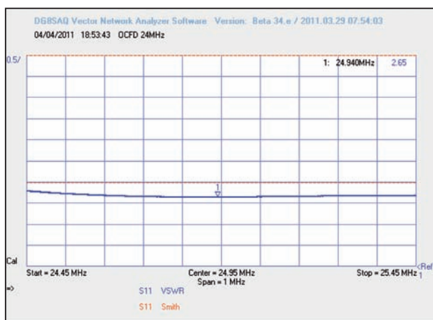
Fig. 15 - SWR misurato dell'antenna in banda 24 MHz
