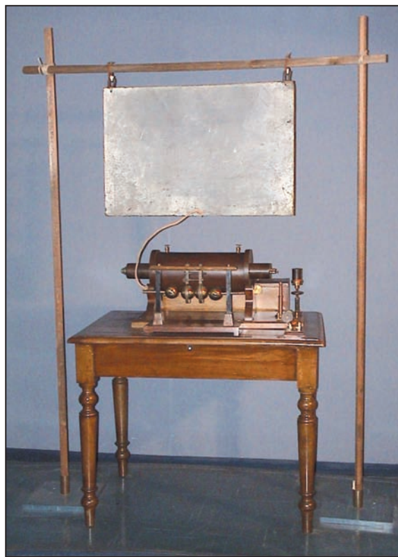
Riproduzione di apparecchio trasmittente marconiano con antenna.
