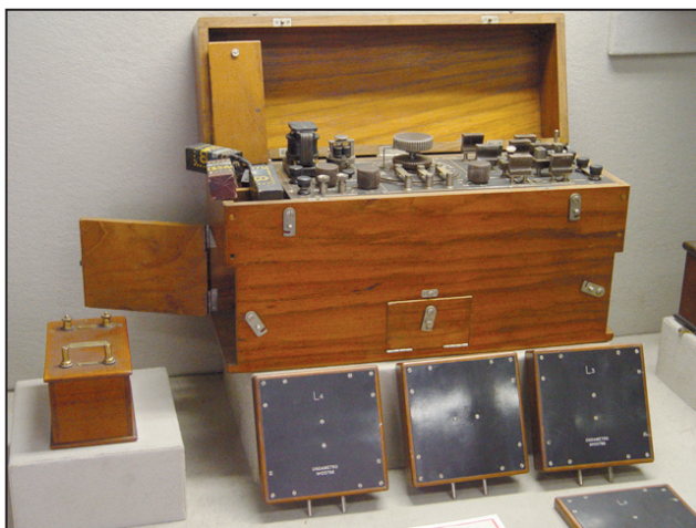
Un ondametro per la misura della lunghezza d'onda dei segnali radiotelegrafici.
