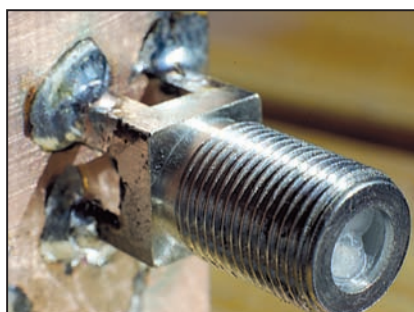
Connettore F: notare le saldature anche sul lato connettore
