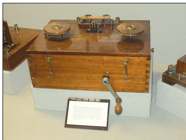
Detector magnetico Marconi ad orologeria, con doppio campo (1906).
