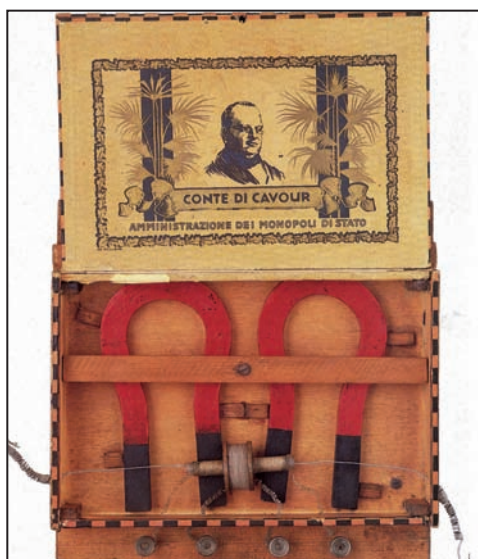
Detector magnetico costruito in una scatola di sigari (1902).
