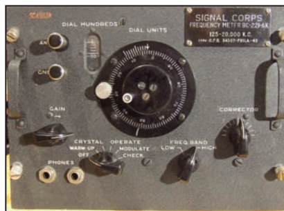
Fig. 1 - Frequenzimetro BC-221-AK. Negli anni '40 permetteva ai militari sintonie e tarature abbastanza accurate.
