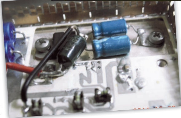
Foto 8 - Particolare della modifica: il circuito BIAS
