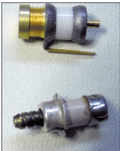
Foto 4 - Il gigatrimmer Johnson ed un compensatore Philips
