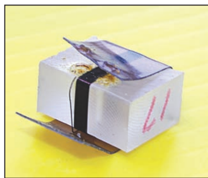
Dettaglio della minuscola bobina di prelievo
