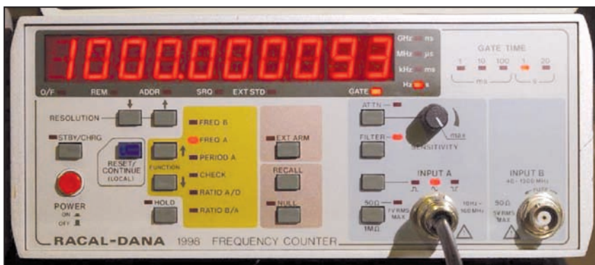
Frequenzimetro a conteggio reciproco Racal 1998 mentre misura, in un secondo, 1.000 Hz con risoluzione al milionesimo di Hz.
