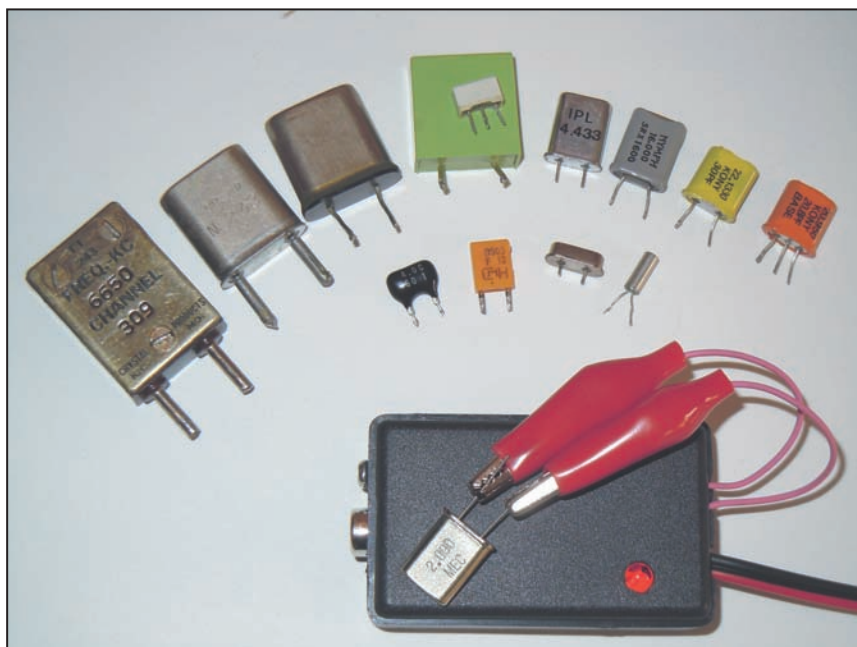
Diversi tipi di quarzi e l'XTAL TEST inserito in un piccolo contenitore plastico
