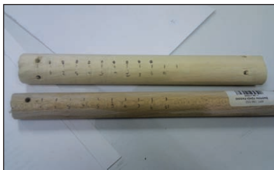
Fig. 3 - Dime per avvolgere gli induttori.
