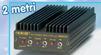
2 metri SR100 VHF – banda 2m Input 4-25W – Out 100W nominali con preamplificatore
