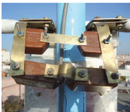
Fig. 22 - Condensatore supplementare per i 160 metri
