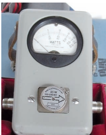
Fig. 10 - Il wattmetro RF della BIRD Electronics - Mod. 43, un vecchio cavallo da battaglia, pressoché intramontabile
