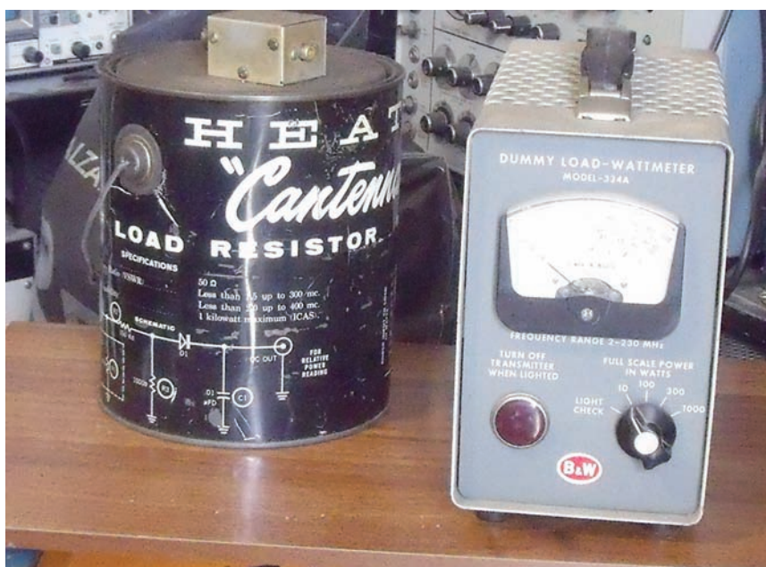
Fig. 4 - Carico artificiale Cantenna della Heathkit e il Dummy load wattmeter mod. 334 A della Barker & Williamson.
