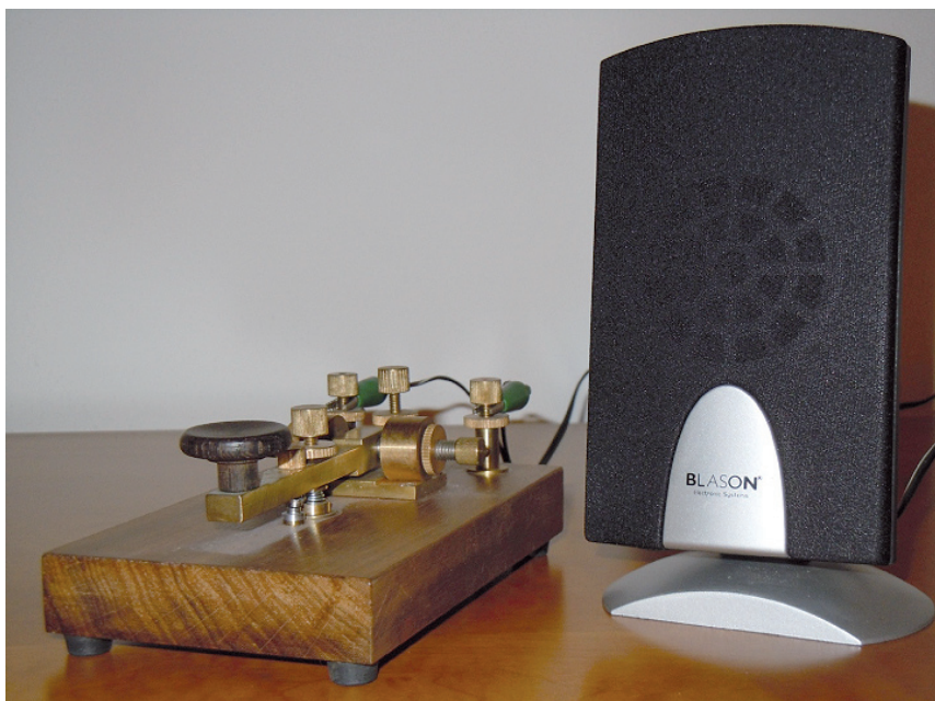
L'oscillatore di nota a realizzazione ultimata collegato a un tasto telegrafico verticale di costruzione artigianale realizzato da IKIGEX Ermes.
