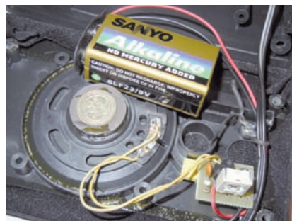
L'oscillatore di nota e la pila di alimentazione inseriti all'interno di una cassa acustica per computer.
