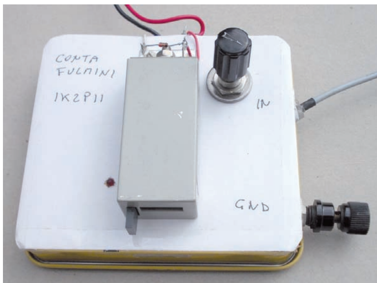
Il contafulmini montato in una scatola di sigari. A destra l'ingresso dell'antenna e il morsetto di terra.
