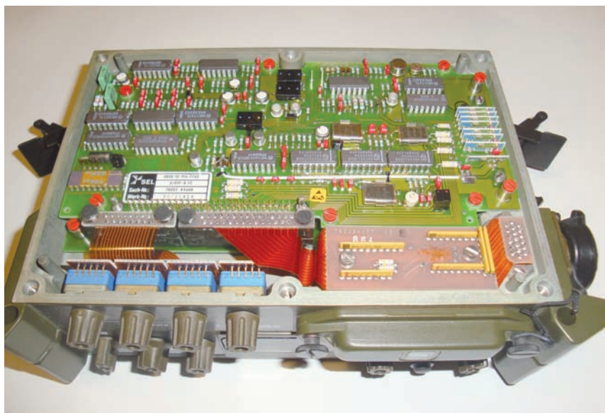
Foto 6 - Lato logica del A/VHF-grundger
