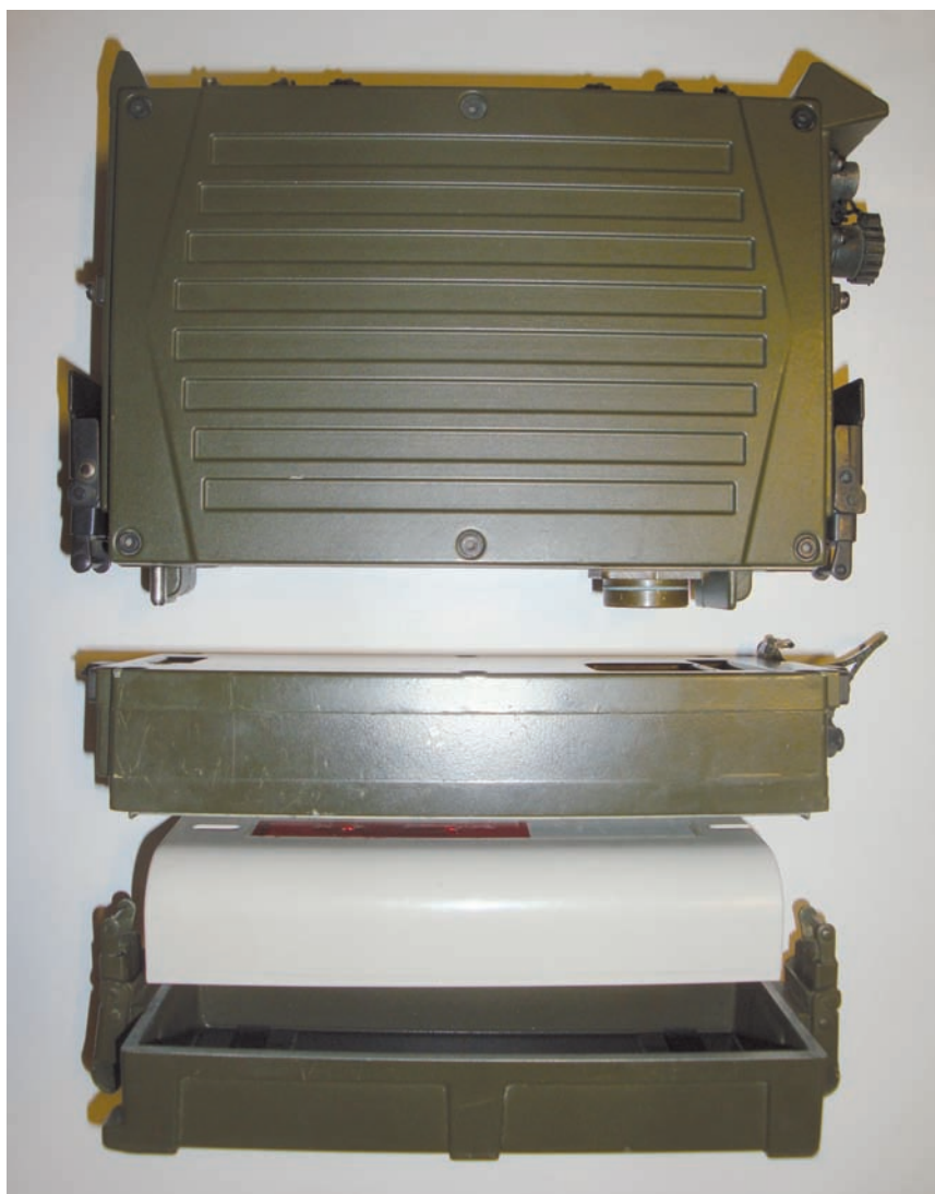
Foto 3 - I moduli costituenti il SEM70: A/VHF-grundger, AT70, blocco batteria, BB70
