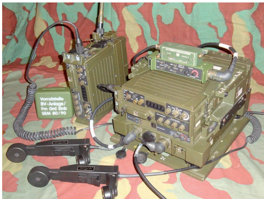
Foto 1 - Il Sem70 e il Sem90 con il telecomando PRZ80 e l'indicatore LED del livello batteria
