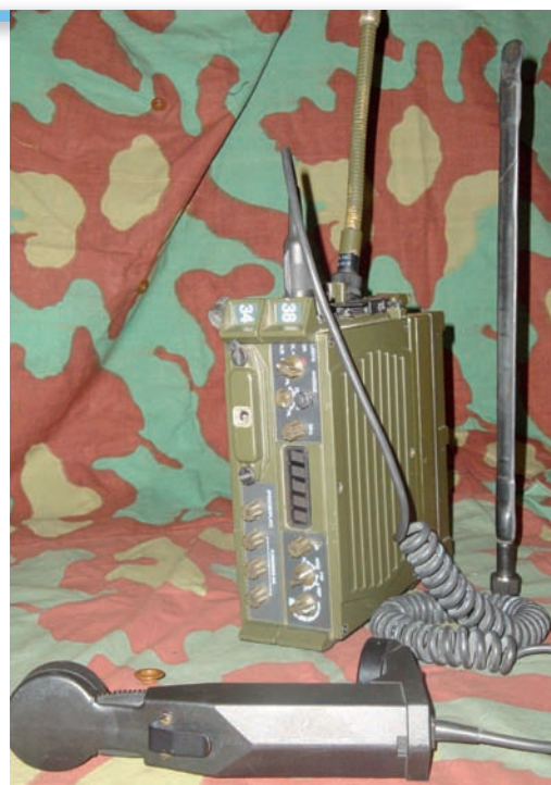
Foto 2 - Il SEM70 operativo con antenna corta e lunga installata
