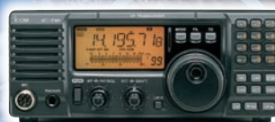
IC-718 HF multimodo 100W
