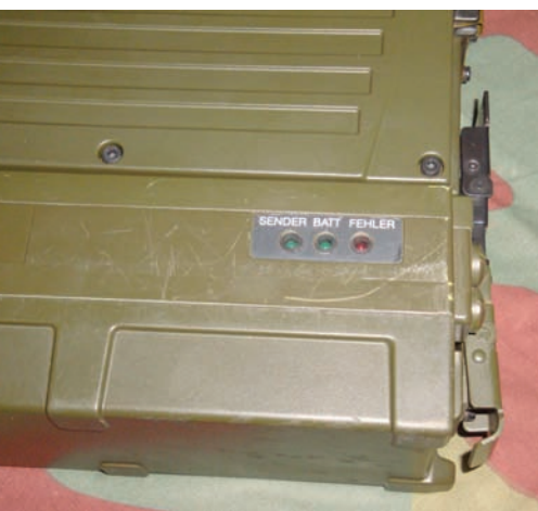
Foto 5 - Dettaglio dei LED di test sul modulo AT70
