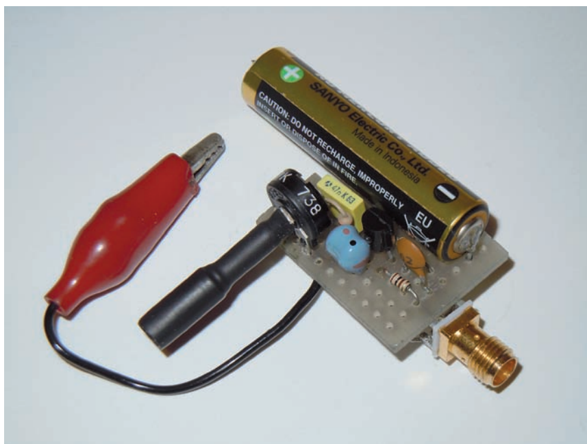
Preamplificatore con il controllo manuale del guadagno.
