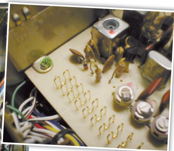
Foto 2 - Il modulo FIX estratto e il particolare dei contatti dorati in cui si inserisce il modulo
