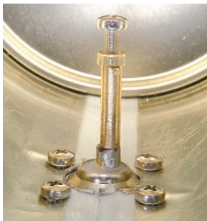
Foto 1 - Visione della parte interna dell'antenna con la vite micrometrica.
