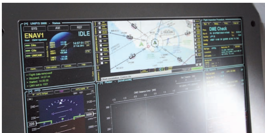
A sinistra in alto sono visualizzate le frequenze sulle quali sta lavorando la console, che possono essere tre per ogni banda.
