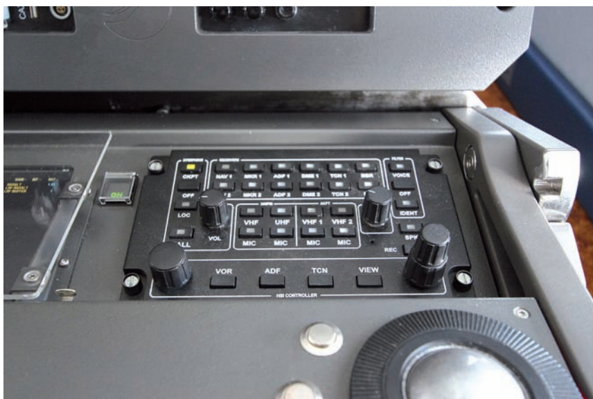
Il pannellino per selezionare gli output radio di comunicazione. Chi non lo vorrebbe nello shack?
