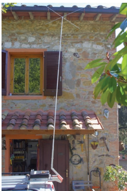
Foto 8 - L'antenna con cappello capacitivo in configurazione "OM"
