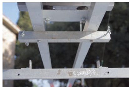
Foto 4 - Fissaggio del "binario" sulla traversa posteriore.
