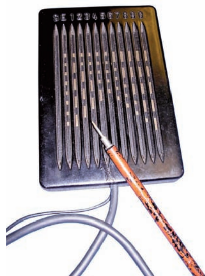
Fig. 2 - Dispositivo utilizzato durante la Seconda Guerra Mondiale dagli agenti dell' Intelligence italiana per trasmettere con facilità messaggi cifrati. Fa parte della Collezione Cremona, Museo delle Telecomunicazioni di Colleferro.
