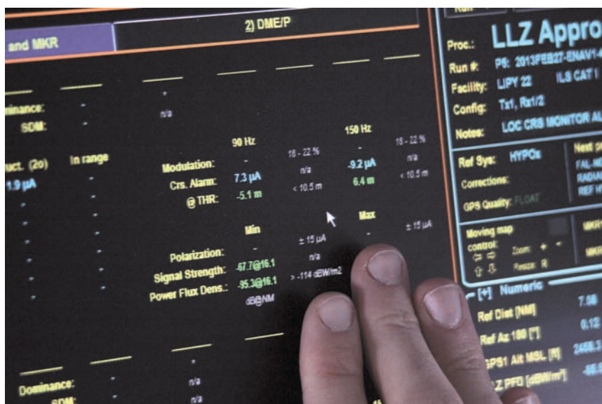
I valori del segnale ricevuto sono visualizzati con colori differenti secondo le loro risposte ai parametri nominali (oppure minimi), richiesti dalle normative internazionali.
