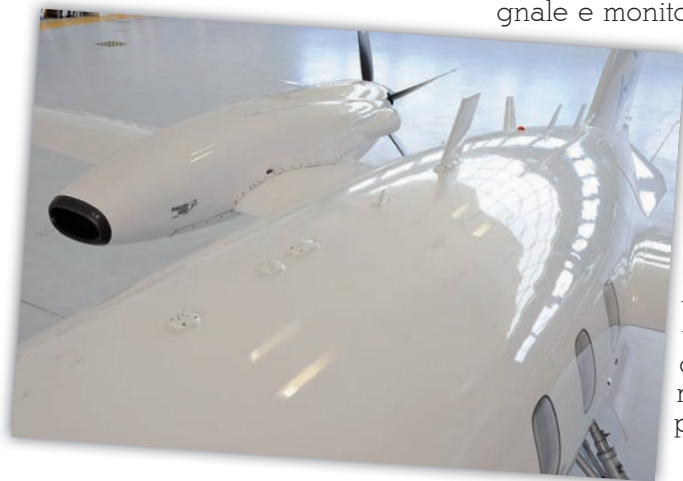
A sinistra, le antenne VHF e UHF sul dorso dell'Avanti II
