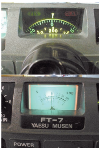
Foto 3 - La scala di sintonia e lo Smeter.
