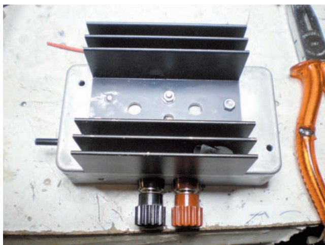
Montaggio del MOSFET, dei diodi Schottky, dello switch termico e del potenziometro di regolazione.
