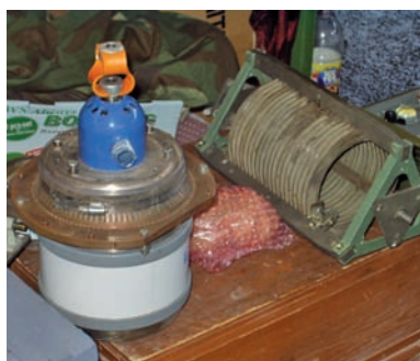
Condensatore sotto vuoto russo, per un'idea delle dimensioni... la bottiglia nell'angolo destro era da 1,5 litri
