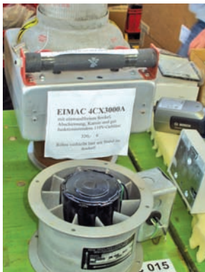
Una valvola 4CX3000A completa di zoccolo, camino e ventola
