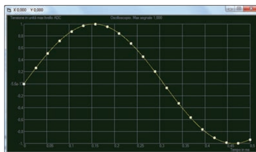
Fig.1 - Segnale a 1600 Hz campionato a 40 kSa/s. In giallo il segnale analogico, mentre i cerchi bianchi sono i valori dei campioni. Si vede un tempo di 0,5 ms.
