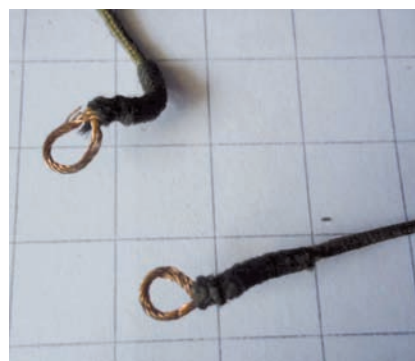
Fig. 12 - Particolare della lavorazione per il capicorda
