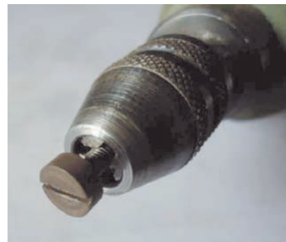
Fig. 8 - Particolare per la pulizia delle viti
