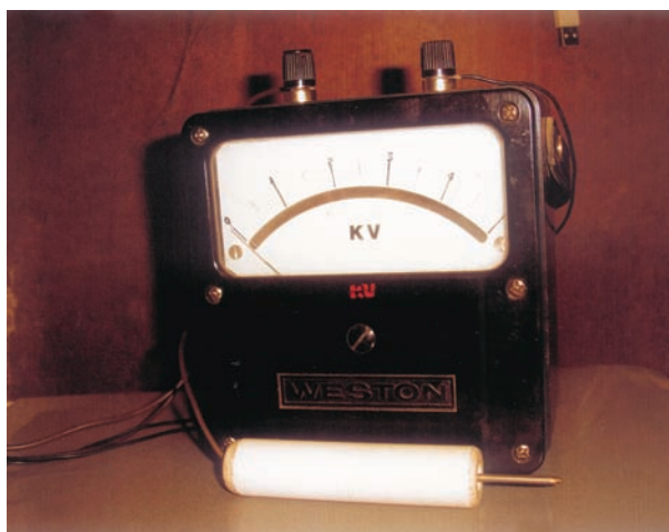
La foto illustra lo strumento. La scatola in bachelite è stata reperita in una bancarella, con lo strumento montato, ma vuota all'interno. Sotto spicca il puntale in teflon autocostituito.
