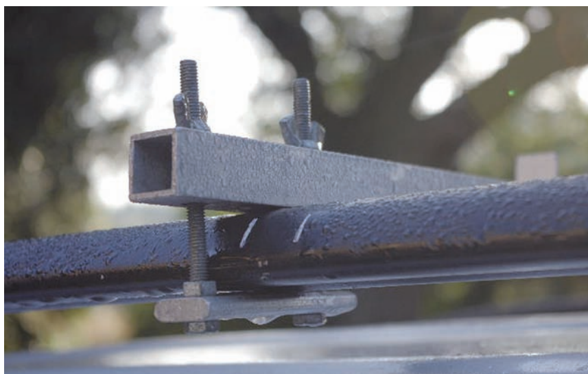
Particolare della realizzazione delle barre trasversali del portabagli.
