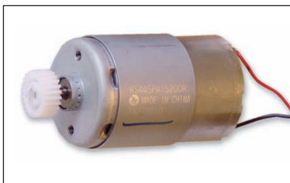
Fig. 4 - Uno dei tre motori elettrici presenti nella stampante, questo modello del diametro di 3 cm da prove effettuate risulta funzionare perfettamente con 12 volt mostrando una discreta coppia.
