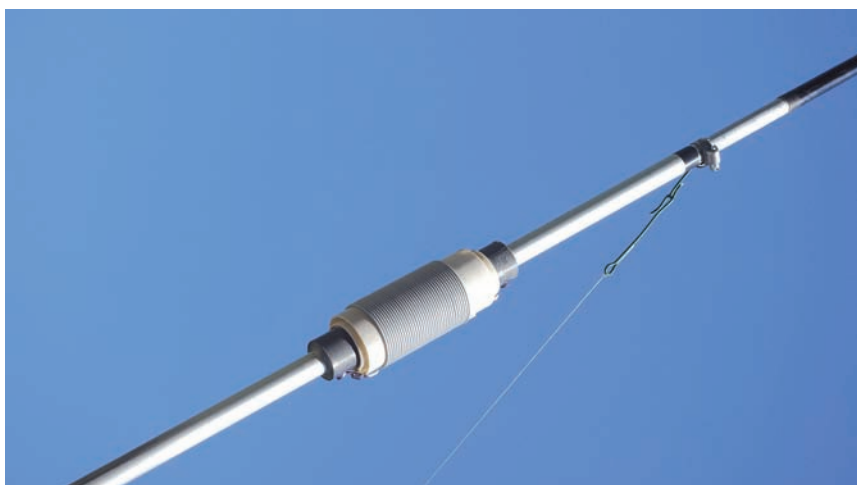
Particolare della bobina dei 40 metri sull'antenna montata e in funzione. Da notare il tirante in nylon (filo da pesca del 6) che serve sia da sicurezza sia per contrastare il vento della corsa.
