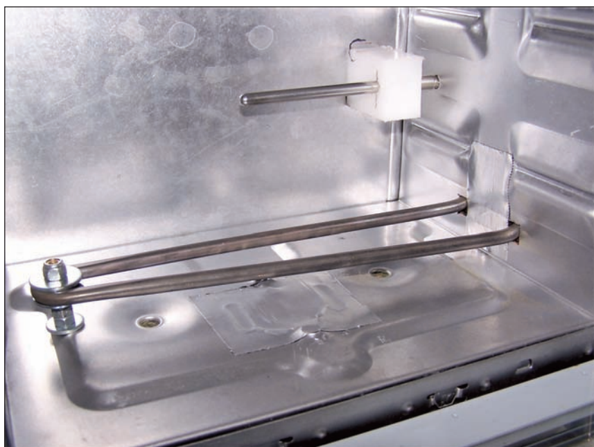
Foto 2 - Vista interna del forno, con in evidenza la nuova resistenza riscaldante e sullo sfondo il sensore di temperatura
