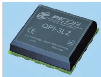
Fig. 3 - Design base del package SiP adottato per la famiglia di dispositivi QPI-3L: i terminali a saldare qui appena visibili sul bordo si sviluppano al di sotto del componente.
