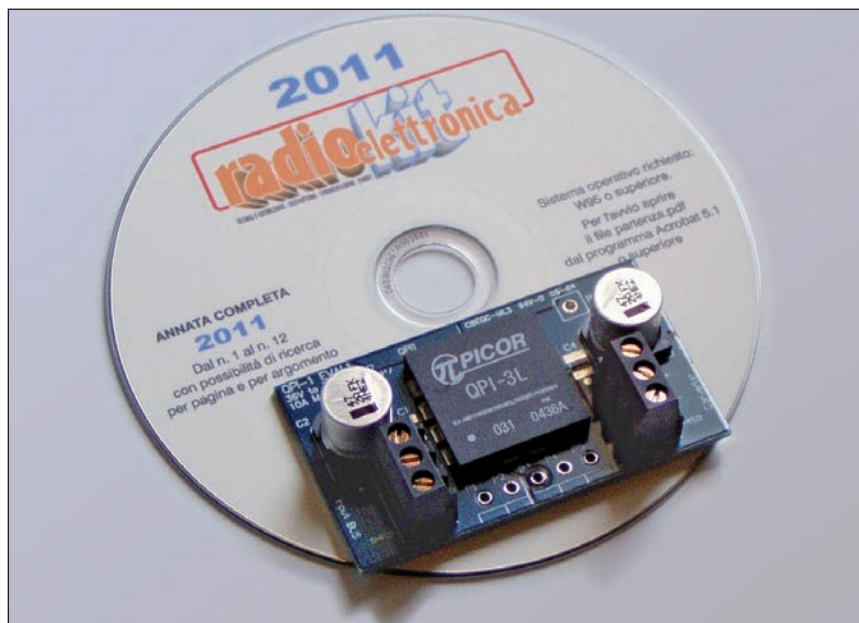
Fig. 1 - Filtro attivo per alimentazione QPI-3L della Picor, gestisce una potenza di picco sull'ordine dei 400 W con un ingombro assai limitato come evidenzia per raffronto il CD-ROM di Radiokit Elettronica su cui è appoggiato.
