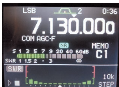
Fig. 3 - BW e ROS relativi alla EH per i 40m (schermata Icom IC-7000)
