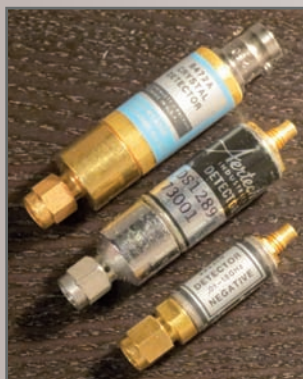
MWRX-1: ricevitore a cristallo per 10 GHz
