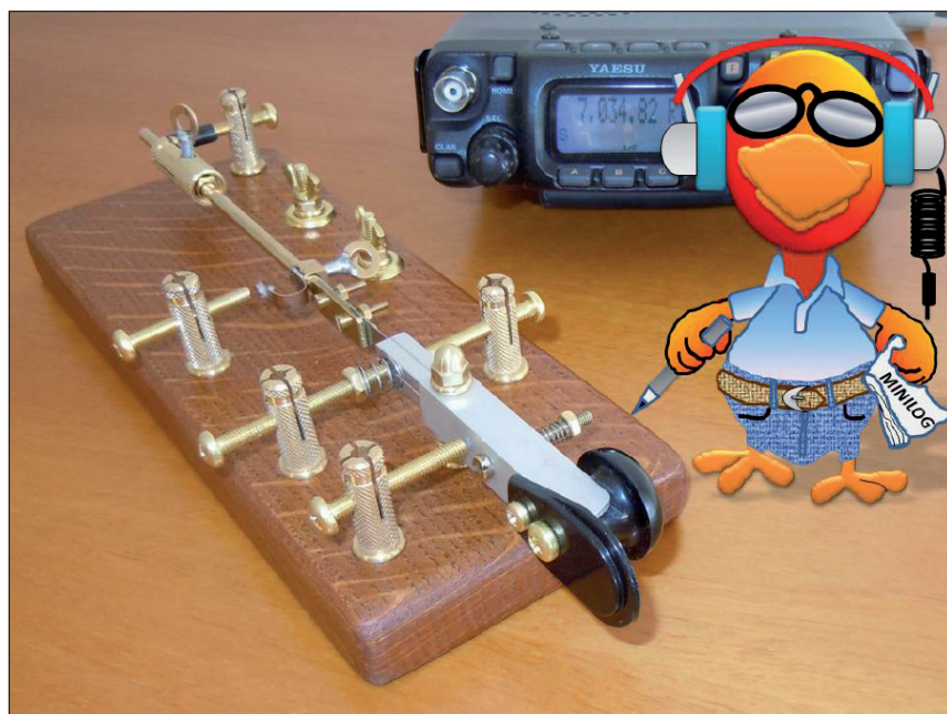
Morse one Wood a realizzazione ultimata
