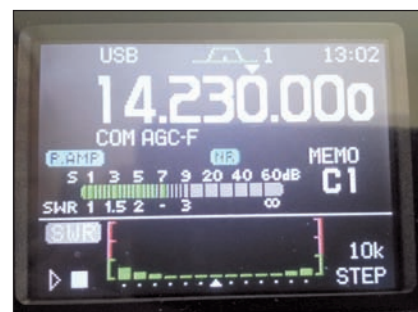
Fig. 2 - BW e ROS relativi alla EH per i 20m (schermata Icom IC-7000)
