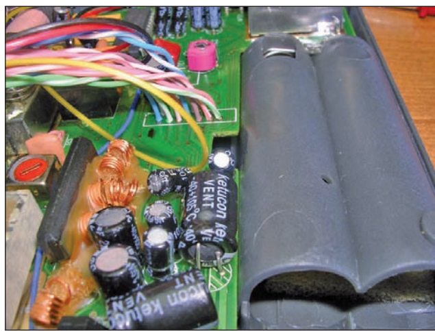
Rifacimento lato analogico
