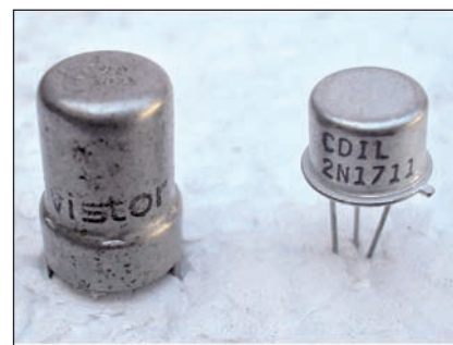
Fig. 3 - Il Nuvistor insieme con il famosissimo 2N 1711. Il confronto con una tecnologia che, seppure non di avanguardia assoluta, è stata considerata perfettamente commerciale ed attuale almeno fino all'inizio del ventunesimo secolo, dimostra il livello di raffinatezza tecnologica a cui questi particolari tubi elettronici erano pervenuti.
