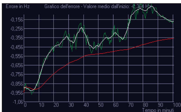
Fig. 5 - Risultato finale. Il grafico condensa 100 minuti di prova. Se c'è stato fading col relativo Doppler, come in questo caso, la curva che meglio rappresenta la stabilità è quella bianca; in assenza di fading (propagazione per onda di terra o campione di laboratorio) è quella verde.
