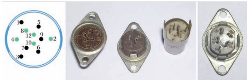
Fig. 2 - Fondello e zoccolo Nuvistor in dettaglio. A sinistra è indicata l'esatta numerazione dei piedini presenti nel fondello: quelli attivi sono colorati in verde.
