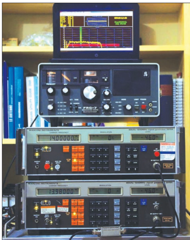
Fig. 1 - Sinad e due Marconi 2019A misurano la IMD3 di un FRG-7. Per molte misure basta un solo generatore. La disposizione è adatta alla foto, ma non alle misure: RX e generatori devono essere più distanti.
