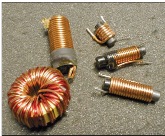
Foto 5 - Nuclei e filo recuperato da alimentatori ex PC
