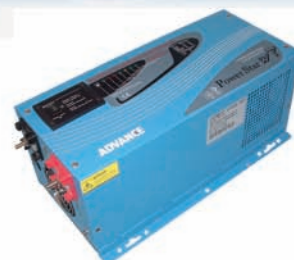
Inverter UPS LF con trasformatore onda sinusoidale pura potenze in uscita da 1KW a 3KW per potenze di spunto elevate
