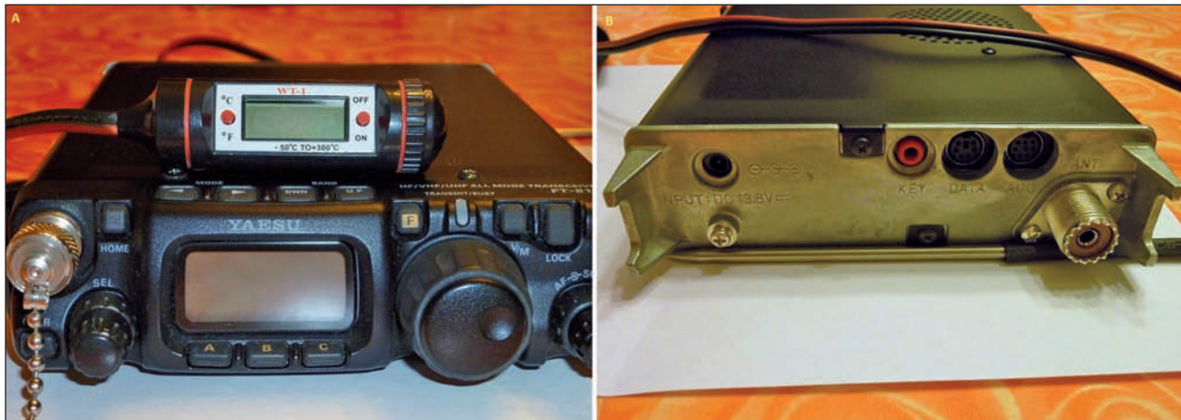
Fig. 5 A – 5 B – Installazione del termometro
