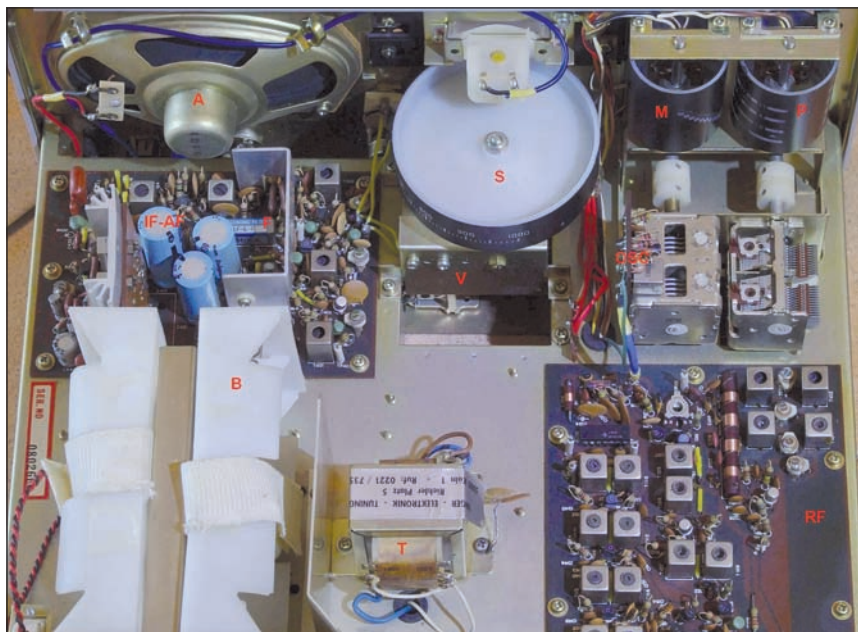
Interno del ricevitore. A altoparlante; B contenitore batterie; F filtro ceramico; IF-AF circuiti con 2 a e 3 a IF e amplificatore audio; M scala dei MHz; OSC oscillatore dei MHz (Oscillator Unit); P scala del preselettore; RF circuiti a RF e 1-a IF, fino al 2-o mixer; S scala principale di sintonia 0-1.000 kHz; T trasformatore di alimentazione; V variabile della sintonia principale. Sopra la scala principale S si vede lo S-meter, alla sinistra della scala c'è il variabilino delle sintonia fine.
