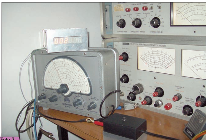
Fig. 5 - Errori di lettura sulla scala analogica dello strumento EP57
